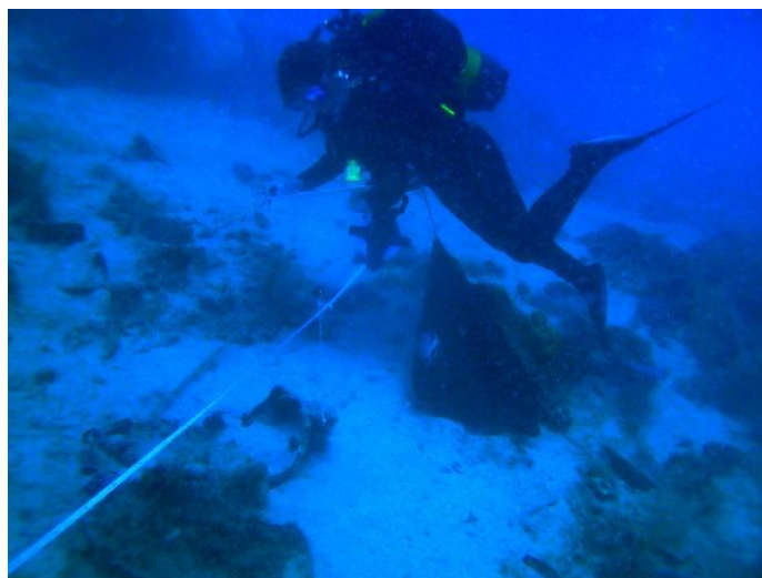
Εικ.2.4: Μέτρηση αποστάσεων με μετροταινία
