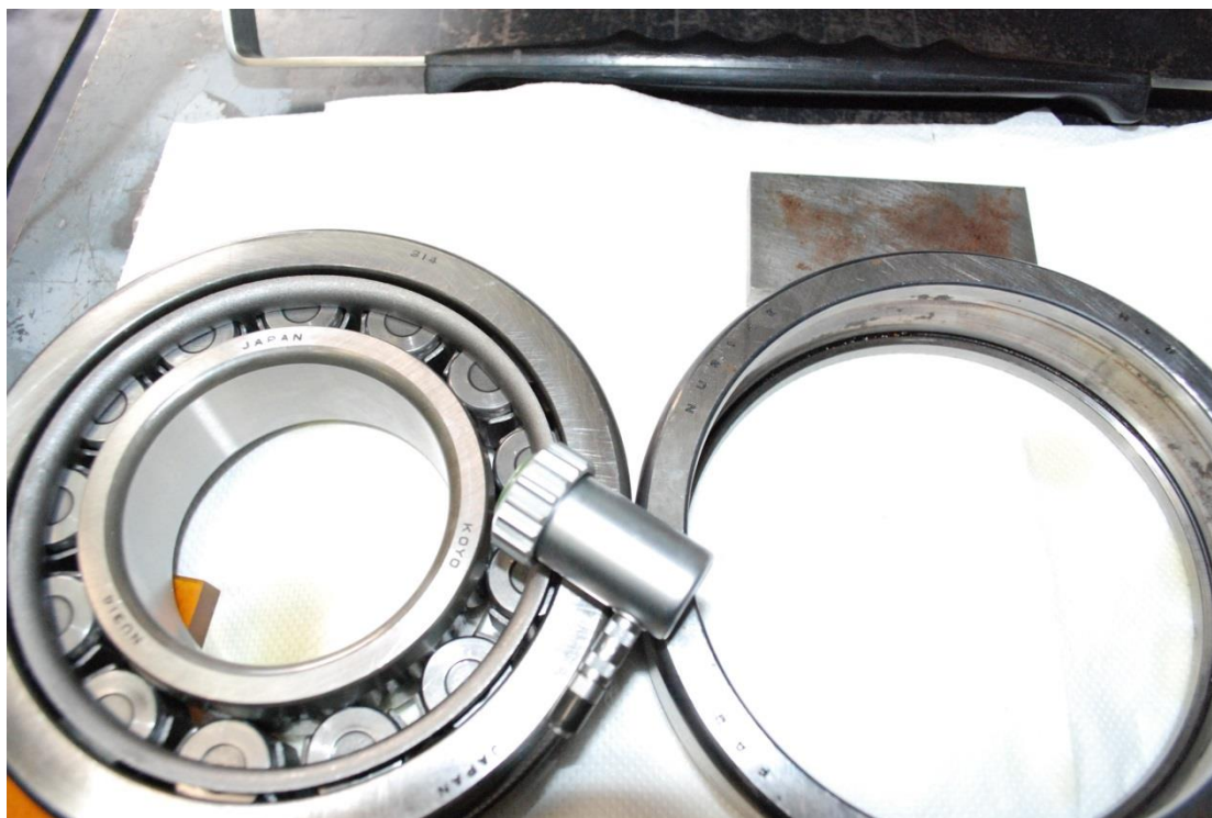
Εικόνα 57: Πείραμα προσδιορισμού της εσωτερικής μηχανικής φθοράς. Αριστερά βρίσκεται το παρθένο δοκίμιο και δεξιά το καταπονημένο.
