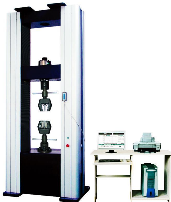
Εικόνα 42: Τυπική συσκευή εφελκυσμού εργαστηρίου
