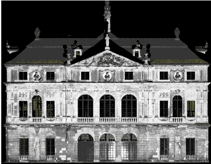
Εικόνα 21: 3D αποτύπωση για εφαρμογές Building Information Modeling - BIM
