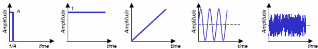
Εικόνα 1.1: Κυματομορφές του σήματος εισόδου
