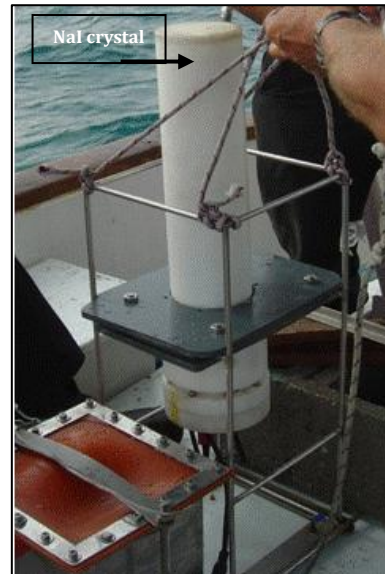
Εικόνα 2.2β: Πειραματική διάταξη μέτρησης στο νερό
