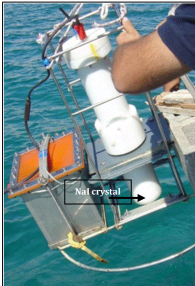
Εικόνα 2.2α: Πειραματική διάταξη μέτρησης στο ίζημα
