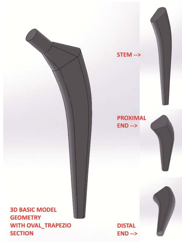
Σχήμα 36: Τρισδιάστατο μοντέλο επιλεγθείσας βασικής γεωμετρίας μέσω SOLIDWORKS
