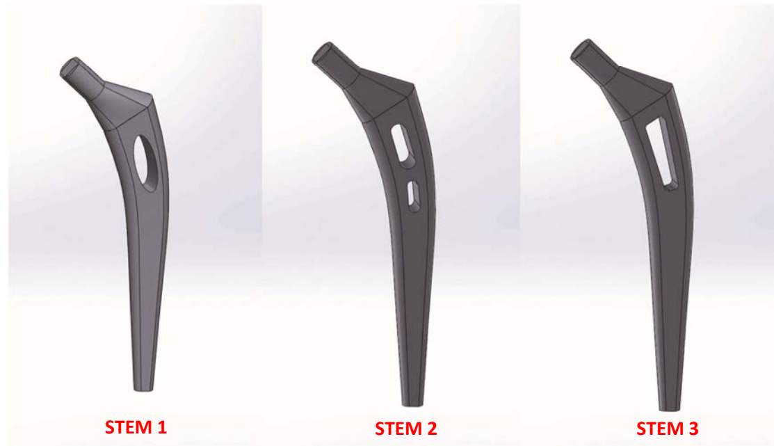
Σχήμα 39: Τρισδιάστατα μοντέλα των 3 υπό ανάλυση στελεχών.
