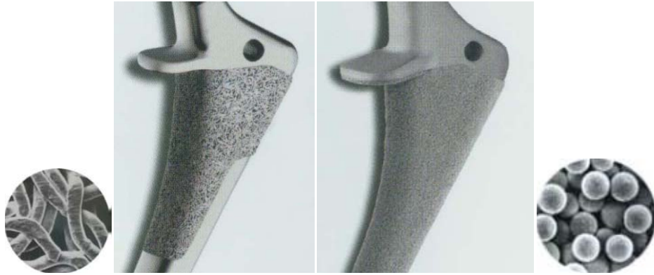
Σχήμα 13: Μεταλλικές επιστρώσεις (ίνες και σφαιρίδια)
