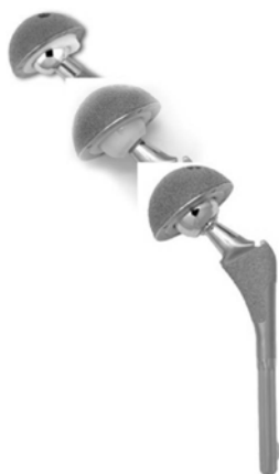
Σχήμα 8: Παραδείγματα τριών τύπων εμφυτευμάτων, Από πάνω προς τα κάτω: μέταλλο-πολυμερές, κεραμικό-κεραμικό, και μέταλλο- μέταλλο.
