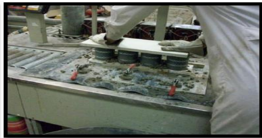
Εικόνα 12. Καλούπωμα δοκιμίων (α) γέμισμα μητρών και (β) συμπίκνωση με δόνηση.
