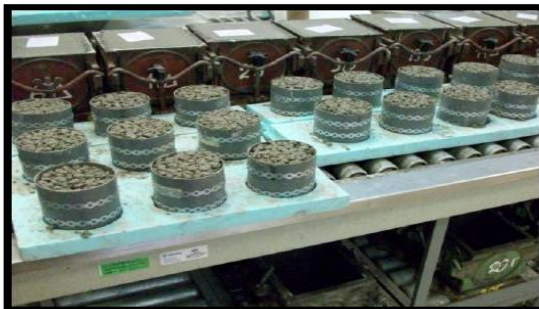
Εικόνα 12. Καλούπωμα δοκιμίων (α) γέμισμα μητρών και (β) συμπίκνωση με δόνηση.
