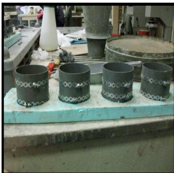
Εικόνα 7. Μήτρες PVC για τη σκυροδέτηση κυλινδρικών δοκιμίων διαστάσεων (100mm)x(100mm)
