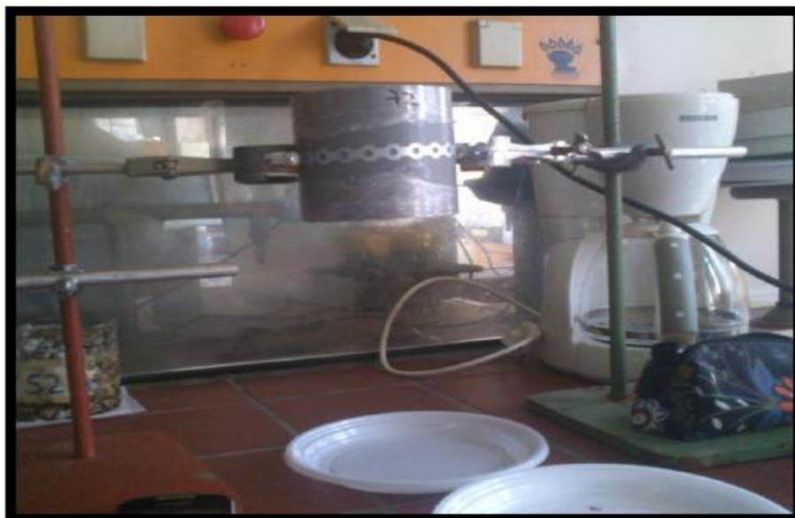
Εικόνα 100. Πειραματική διάταξη για τη διέλευση οργανικών ρυπαντών.
