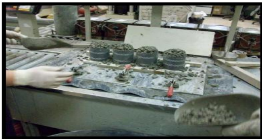
Εικόνα 12. Καλούπωμα δοκιμίων (α) γέμισμα μητρών και (β) συμπίκνωση με δόνηση.
