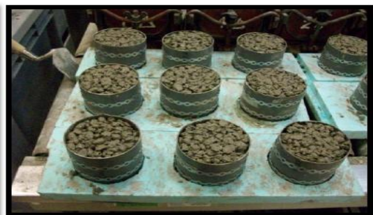
Εικόνα 12. Καλούπωμα δοκιμίων (α) γέμισμα μητρών και (β) συμπίκνωση με δόνηση.
