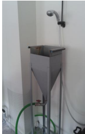
Εικόνα 16. Ιδιοκατασκευή για την μέτρηση της υδατοπερατότητας
