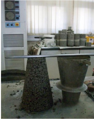
Εικόνα 10. Έλεγχος κάθισης διαπερατού σκυροδέματος
