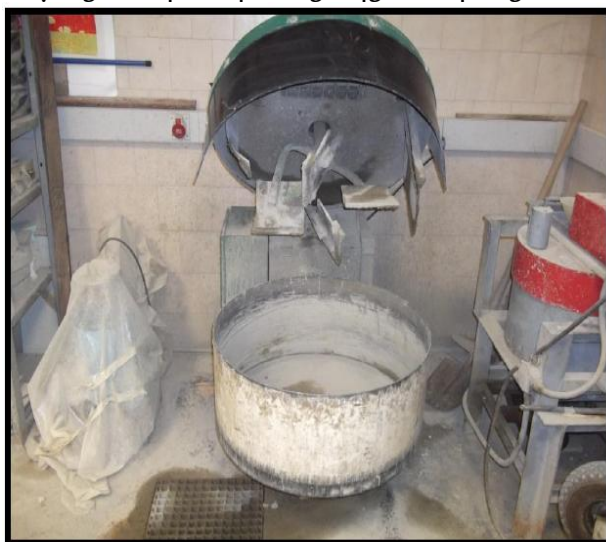
Εικόνα 8. Ηλεκτροκίνητος αναμεικτήρας χωρητικότητας 150L.
