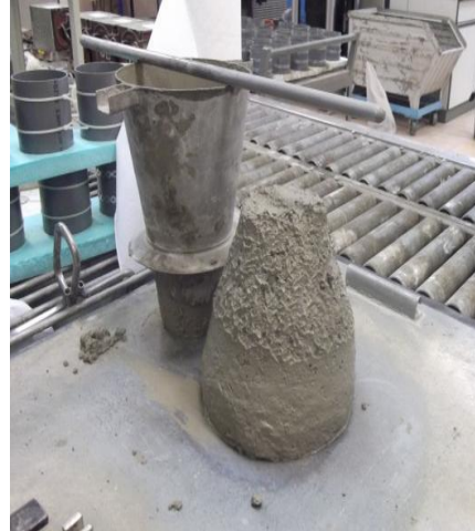
Εικόνα 11. Έλεγχος κάθισης συμβατικού τύπου σκυροδέματος
