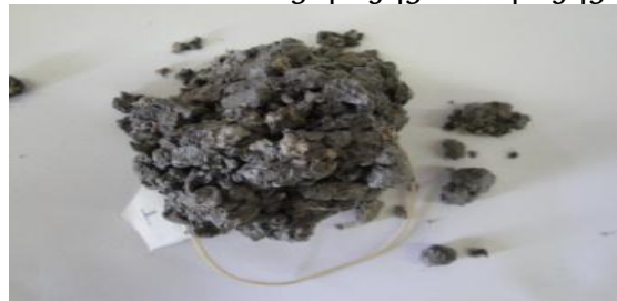
Τελική αστοχία δοκιμίου Εικόνα 55. 44 ος κύκλος ψύξης-απόψυξης SCDP1
