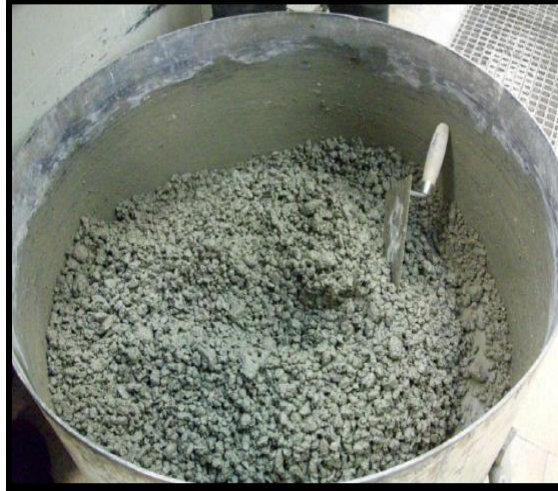
Εικόνα 9. Παρασκευή σύνθεσης διαπερατού σκυροδέματος
