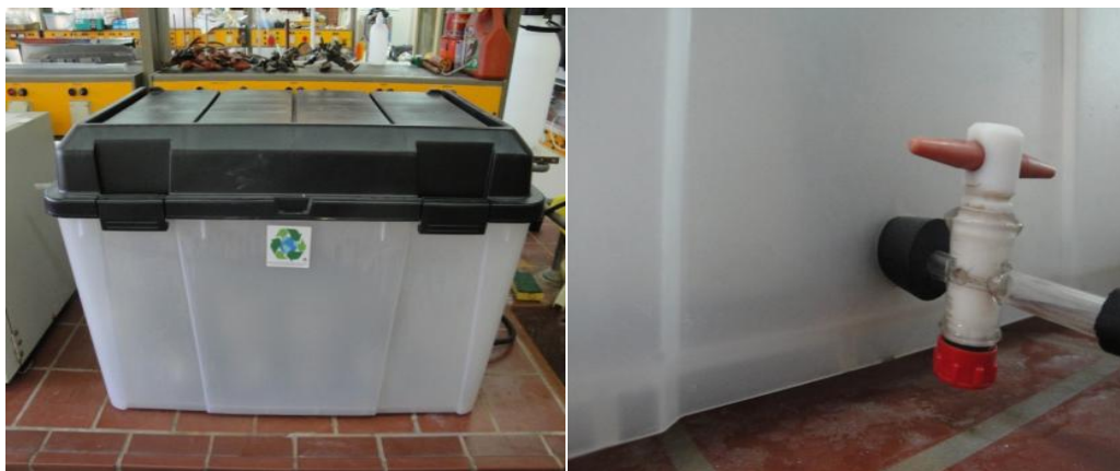
Εικόνα 89 (α), (β). (α) Θάλαμος ιδιοκατασκευής υψηλών συγκεντρώσεων CO 2 , (β) Οπή εισόδου CO 2 .
