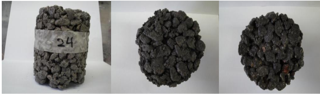
Όψη Επιφάνεια 1 Επιφάνεια 2 Εικόνα 30. 30 ος κύκλος ψύξης-απόψυξης LP2
