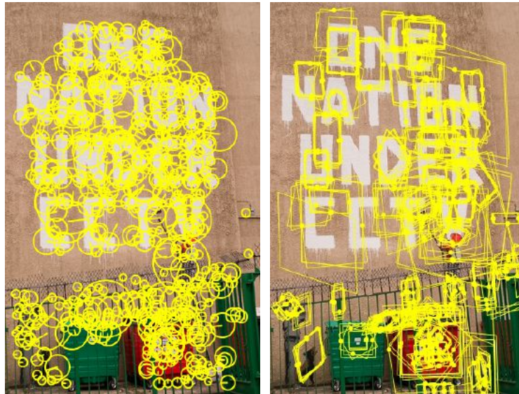
Σχήμα 1.1: Αριστερά: Σύνολο τοπικών χαρακτηριστικών SURF, αναλλοίωτων ως προς κλιμάκωση και περιστροφή. Δεξιά: Σύνολο τοπικών χαρακτηριστικών Hessian Affine, αφινικά αναλλοίωτων.
