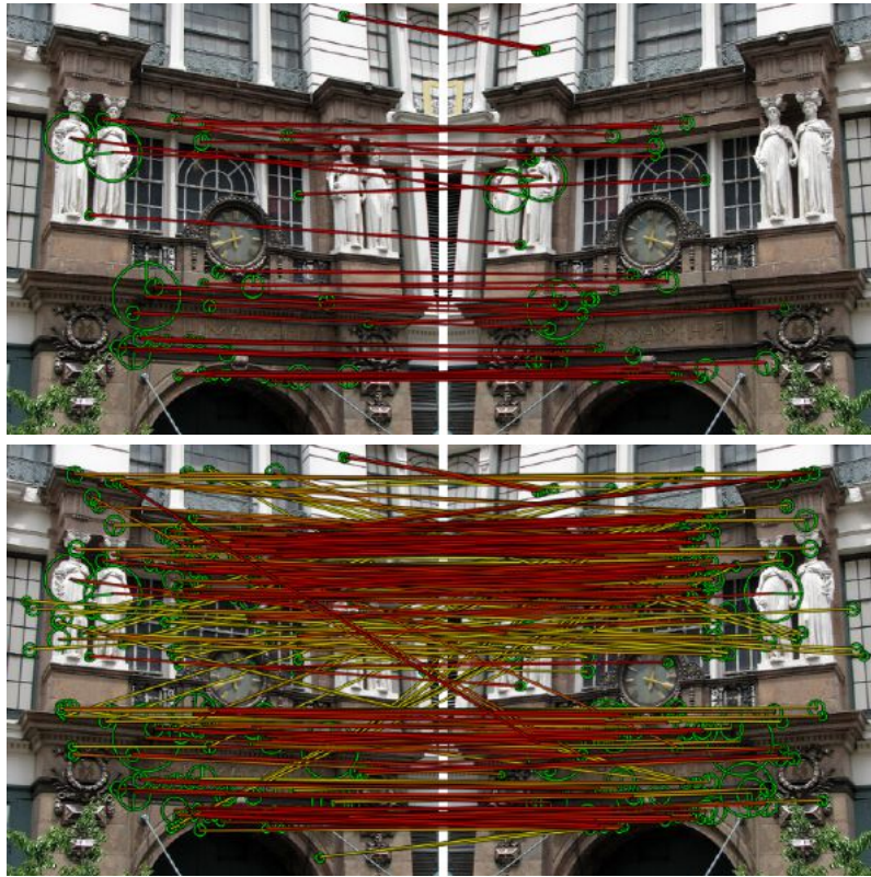
Σχήμα 4.5: Ανάστροφο ταίριασμα με την μέθοδο HPSM και L = 5 επίπεδα. (Πάνω) αντιστοιχίες σε ένα κytίο του επιπέδου 0, οι οποίες αποκαλύπτουν μία ομάδα συμμετρικών περιοχών. (Κάτω) όλες οι αντιστοιχίες, με τις κόκκινες (κίτρινες) να είναι οι πιο ισχυρές (αδύναμες).
