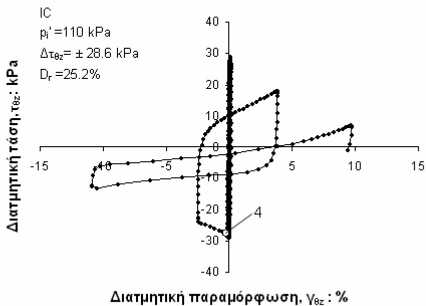
Σχήμα 7.4. Ανακυκλική φόρτιση σε χαλαρό, ισότροπα στερεοποιημένο (IC) δοκίμιο άμμου Ottawa (OTT18) υπό συνθήκες εμποδιζόμενης στράγγισης με D_r=25.2\% , \rho_i'=110 \text{ kPa} και \Delta\tau_{\theta z}=\pm 28.6 \text{ kPa} : καμπύλη τάσεων - παραμορφώσεων
