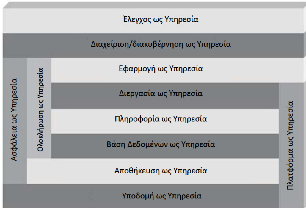
Σχήμα 2.1: Στρώματα που αντιπροσωπεύουν τις υποστηριζόμενες υπηρεσίες του Μοντέλου Υπηρεσιών Νέφους
