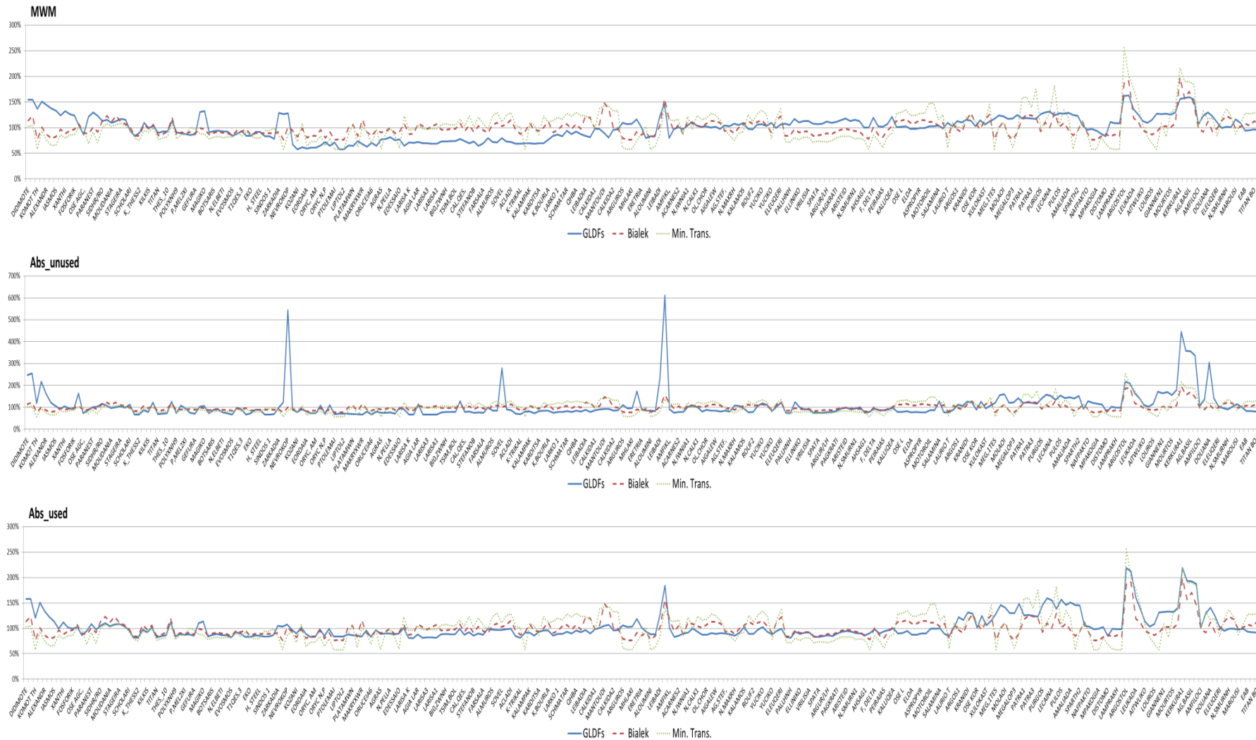
Σχήμα 2.15: Χρεώσεις χρήσης για τα 266 φορτία του ελληνικού διασυνδεδεμένου συστήματος μεταφοράς ως ποσοστό της postage stamp για επίπεδο φορτίου 10000MW χρησιμοποιώντας τις τρεις μεθόδους ανίχνευσης
