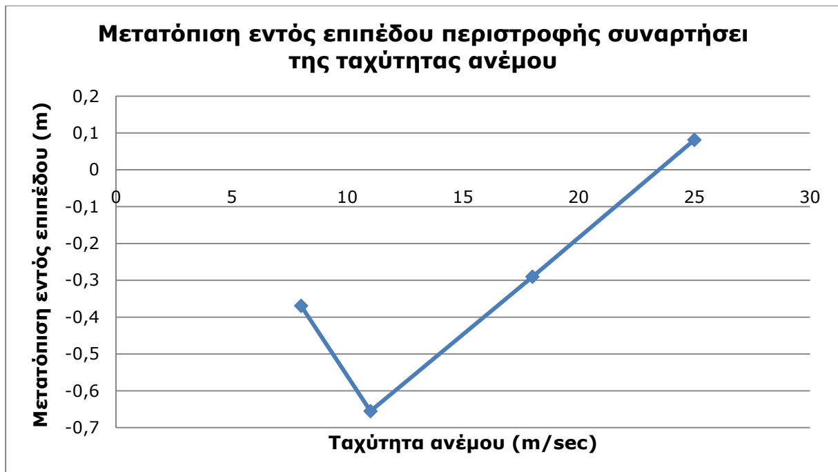
Σχήμα 7.4: Διάγραμμα μεταβολής της μετατόπισης της ακραίας θέσης του πτερυγίου εντός του επιπέδου περιστροφής συναρτήσει της ταχύτητας του ανέμου.
