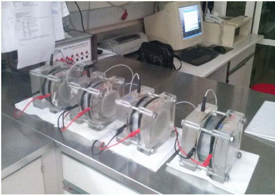
Σχήμα VI.3. Διατάξεις επιταχυνόμενου τεστ διαπερατότητας χλωριόντων ASTM C1202
