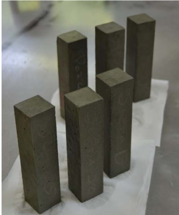
Σχήμα VI.1. Δοκίμια κονιάματος με συνθέσεις S και P υποκατάστασης 5, 10, 15% σε ηλικία 90 ημερών, μετά την έξοδο τους από τη δεξαμενή νερού και πριν από την μέτρηση αντοχών θλίψης
