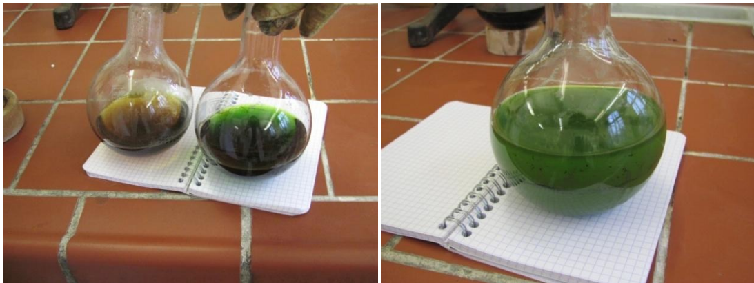
Εικόνα 13: Εκχυλίσματα Soxhlet με νερό και EtOH (αριστ.), EtOH μετά από προσθήκη 200 mL νερού (δεξιά).
