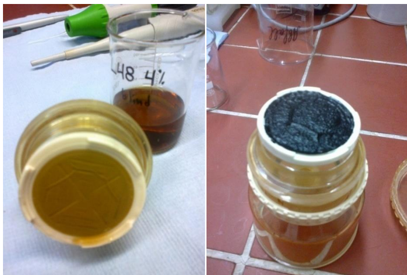
Εικόνα 17: Μembrάνη κυτταρίνης μετά τη διήθηση χωρίς ενεργό άνθρακα (αριστερά) και με ενεργό άνθρακα (δεξιά).
