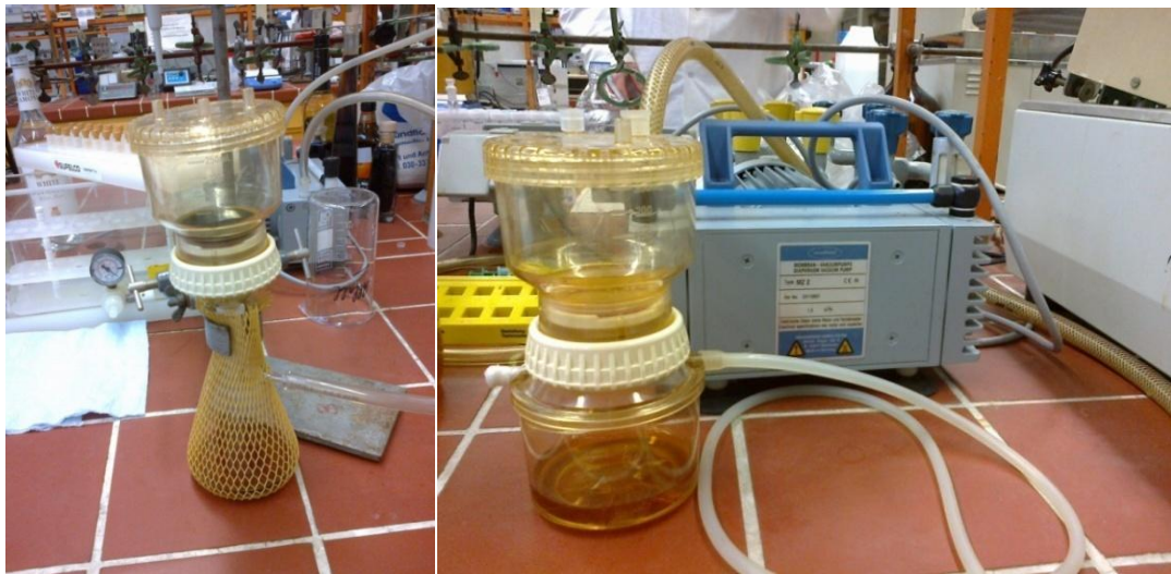
Εικόνα 16: Συσκευές διήθησης υπό κενό που χρησιμοποιήθηκαν για τον αποχρωματισμό του εκχυλίσματος με ενεργό άνθρακα.
