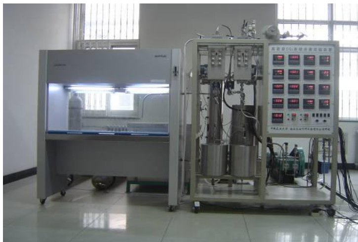
Εικόνα 4.5: Γραμμή παραγωγής τροφίμων με πυκνή φάση διοξειδίου του άνθρακα συνεχούς ροής (βιομηχανικής κλίμακας μονάδα που δεν έχει προς το παρόν διατεθεί σε βιομηχανίες τροφίμων)
