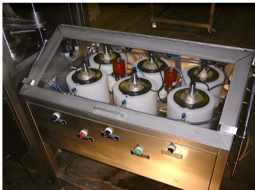
Εικόνα 6.2 Λεπτομερής άποψη της μονάδας με τα 6 κελιά ΥΠ των 42ml το καθένα, που χρησιμοποιείται για κινητικές μελέτες.
