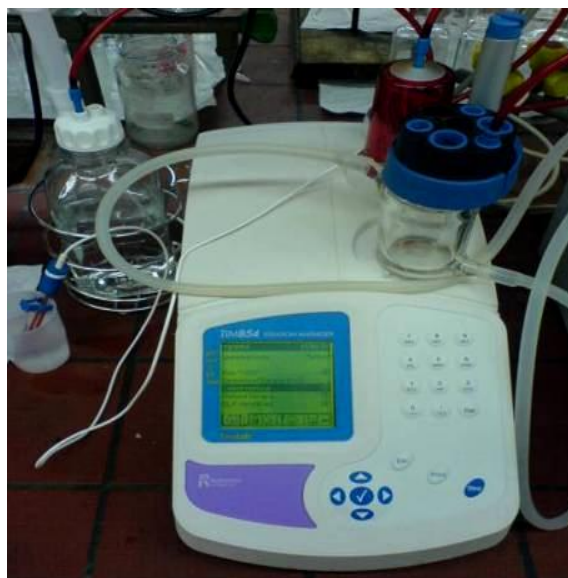
Εικόνα 6.3: ο αυτόματος τιτλοδότης που χρησιμοποιήθηκε για τη μέτρηση της ενεργότητας ΠΜΕ. Διακρίνεται η κυψελίδα μέτρησης η οποία διατηρείται σε σταθερή θερμοκρασία 30°C μέσω κυκλοφορίας θερμού νερού καθώς και η φιάλη με το διάλυμα NaOH (δεξιά)
