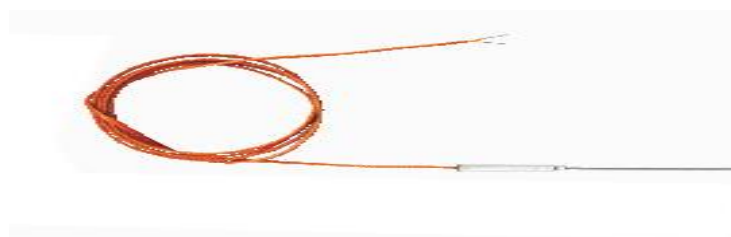
Σχήμα 3.14 Θερμοστοιχείο τύπου K που χρησιμοποιήθηκε
