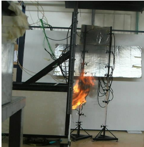
Σχήμα 4.12 Εξερχόμενη φλόγα, 120sec μετά την ανάφλεξη (Πείραμα A2).
