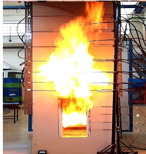
Σχήμα 4.47 Εξερχόμενη φλόγα, 360sec μετά την ανάφλεξη (Πείραμα A4).
