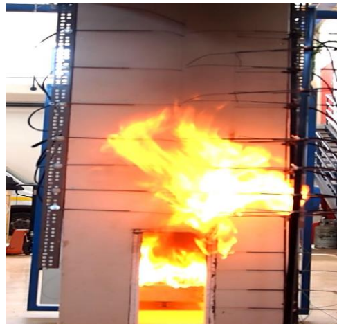
Σχήμα 4.40 Εξερχόμενη φλόγα, 240sec μετά την ανάφλεξη (Πείραμα A3).
