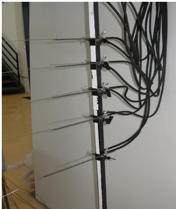
Σχήμα 3.20 Φωτογραφία στύλου, όπου φαίνονται τα χαλύβδινα στελέχη στα οποία στηρίζονται τα θερμοστοιχεία
