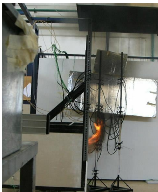
Σχήμα 4.119 Εξερχόμενη φλόγα, 60sec μετά την ανάφλεξη (Πείραμα A8).
