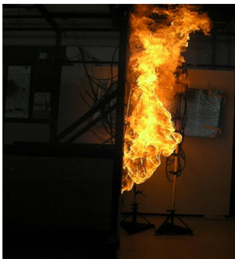
Σχήμα 4.54 Εξερχόμενης φλόγας 360sec μετά την ανάφλεξη (Πείραμα A5).
