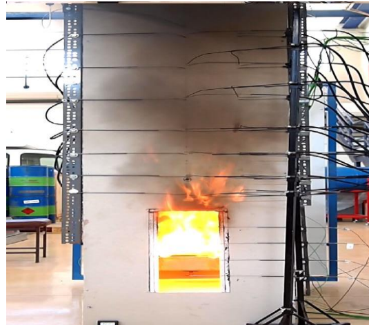
Σχήμα 4.43 Εξερχόμενη φλόγα, 65sec μετά την ανάφλεξη (Πείραμα A4).
