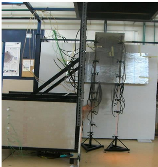
Σχήμα 4.48 Εξερχόμενης φλόγας 30sec μετά την ανάφλεξη (Πείραμα A5).
