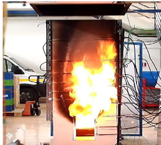
Σχήμα 4.5 Εξερχόμενη φλόγα, 120sec μετά την ανάφλεξη (Πείραμα A1).
