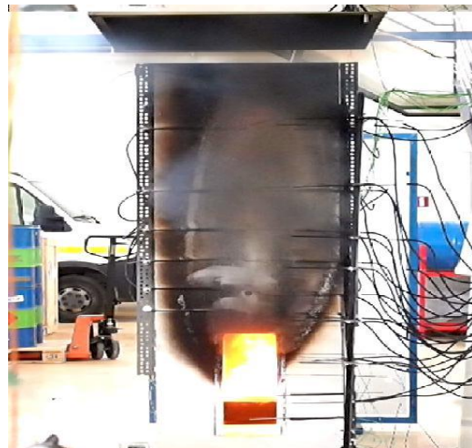
Σχήμα 4.11 Εξερχόμενη φλόγα, 45sec μετά την ανάφλεξη (Πείραμα A2).
