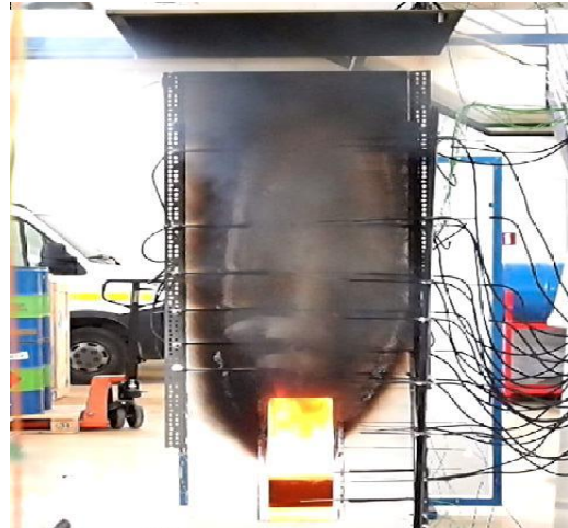
Σχήμα 4.3 Εξερχόμενη φλόγα, 50sec μετά την ανάφλεξη (Πείραμα A1).
