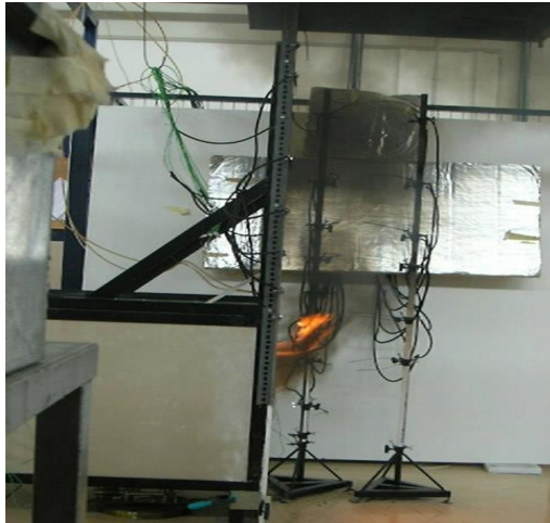
Σχήμα 4.2 Εξερχόμενη φλόγα, 50sec μετά την ανάφλεξη (Πείραμα A1).
