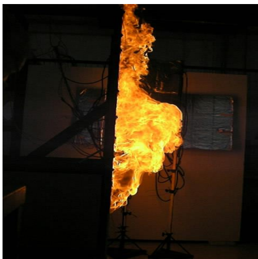
Σχήμα 4.82 Εξερχόμενη φλόγα, 240sec μετά την ανάφλεξη (Πείραμα Α6).
