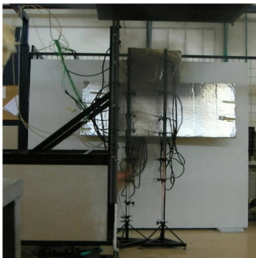
Σχήμα 4.86 Εξερχόμενη φλόγα, 60sec μετά την ανάφλεξη (Πείραμα Β7).
