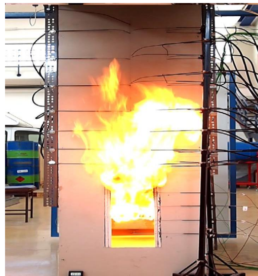
Σχήμα 4.45 Εξερχόμενη φλόγα, 120sec μετά την ανάφλεξη (Πείραμα A4).
