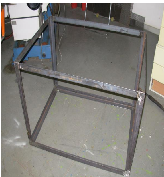
Σχήμα 3.3 Ο βασικός σκελετός του δωματίου πριν τη βαφή
