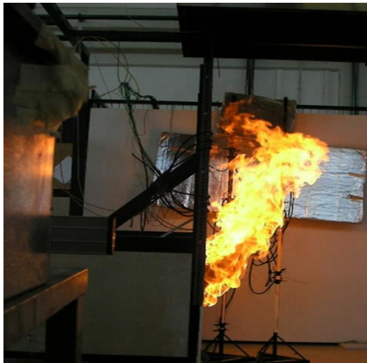
Σχήμα 4.125 Εξερχόμενη φλόγα, 330sec μετά την ανάφλεξη (Πείραμα A8).
