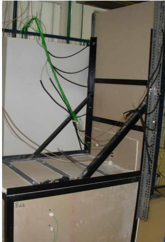
Σχήμα 3.22 Οι καλωδιώσεις των θερμοστοιχείων τοποθετημένες πίσω από την πρόσοψη
