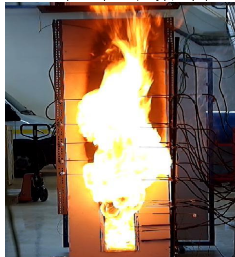
Σχήμα 4.53 Εξερχόμενης φλόγας 240sec μετά την ανάφλεξη (Πείραμα A5).
