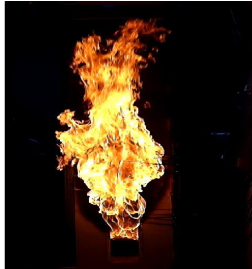
Σχήμα 4.124 Εξερχόμενη φλόγα, 240sec μετά την ανάφλεξη (Πείραμα A8).
