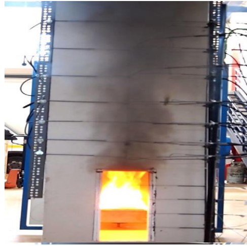
Σχήμα 4.38 Εξερχόμενη φλόγα, 60sec μετά την ανάφλεξη (Πείραμα A3).
