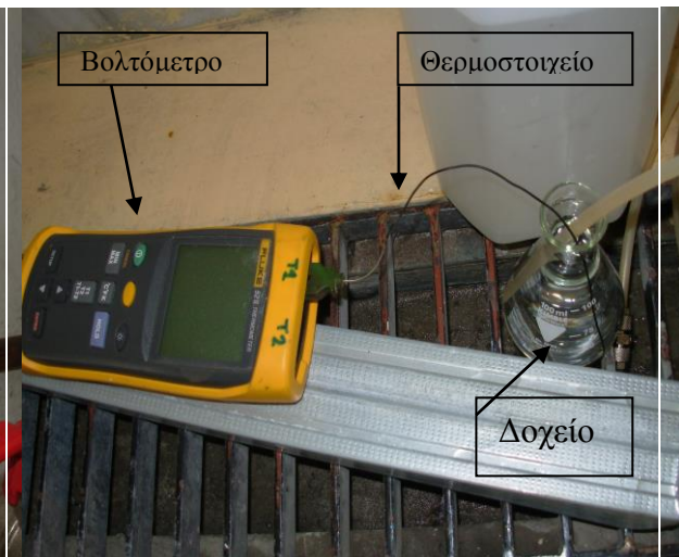
Σχήμα 3.26 Έλεγχος της θερμοκρασίας του νερού εξόδου με θερμοστοιχείο βυθισμένο σε δοχείο.
