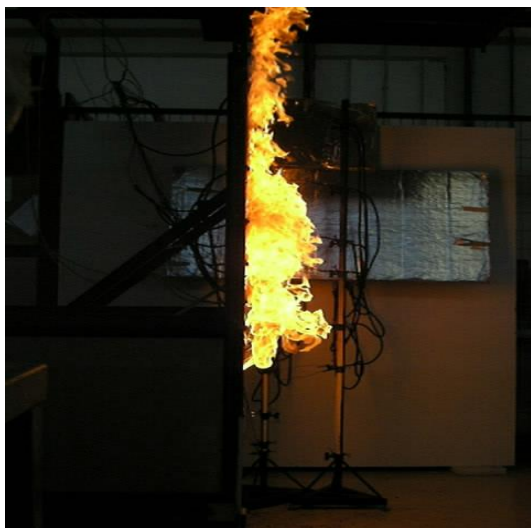
Σχήμα 4.92 Εξερχόμενη φλόγα, 420sec μετά την ανάφλεξη (Πείραμα B7).
