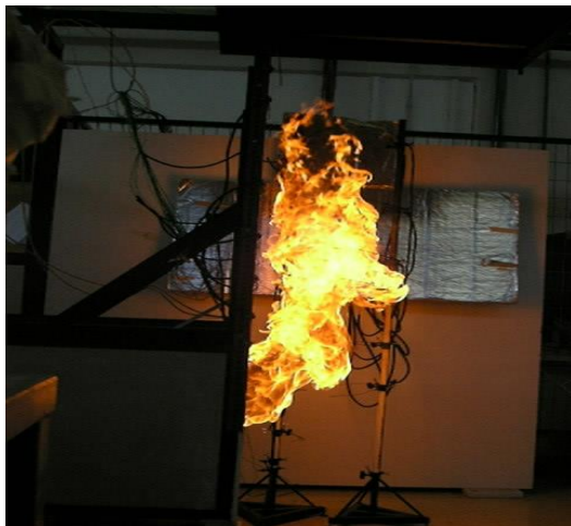
Σχήμα 4.80 Εξερχόμενη φλόγα, 120sec μετά την ανάφλεξη (Πείραμα Α6).
