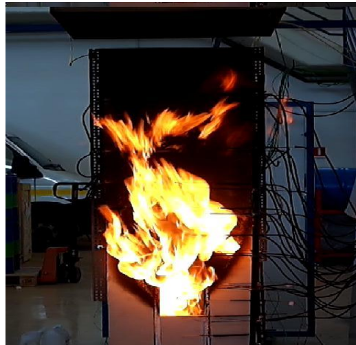
Σχήμα 4.91 Εξερχόμενη φλόγα, 300sec μετά την ανάφλεξη (Πείραμα B7).
