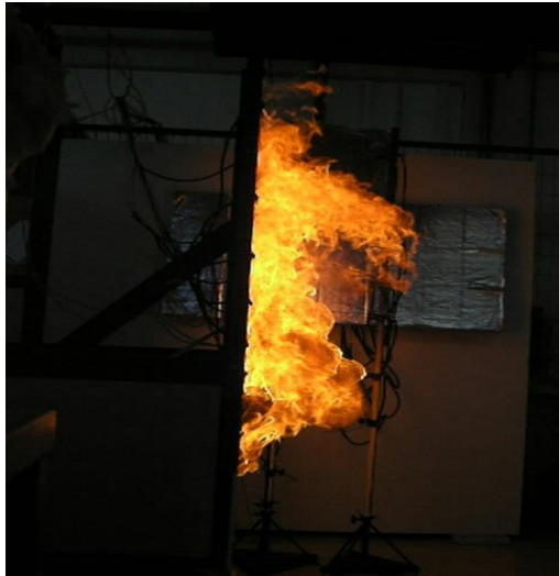
Σχήμα 4.84 Εξερχόμενη φλόγα, 300sec μετά την ανάφλεξη (Πείραμα Α6).
