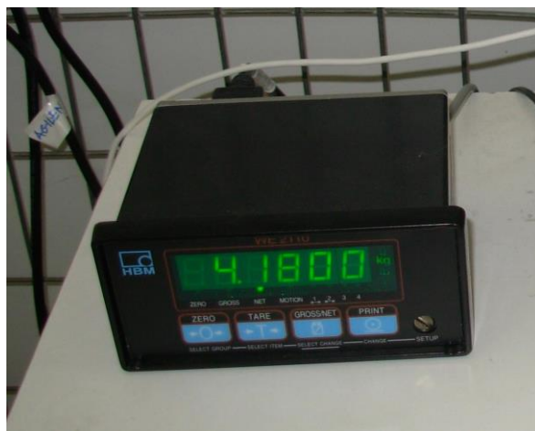
Σχήμα 3.30 Ο ψηφιακός δείκτης, συνδεδεμένος με τη δυναμοκυψέλη
