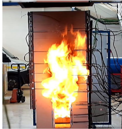
Σχήμα 4.51 Εξερχόμενης φλόγας 120sec μετά την ανάφλεξη (Πείραμα A5).
