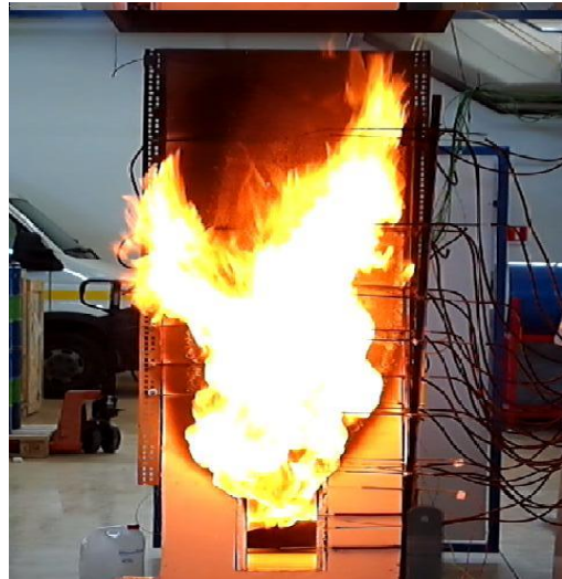
Σχήμα 4.85 Εξερχόμενη φλόγα, 300sec μετά την ανάφλεξη (Πείραμα Α6).
