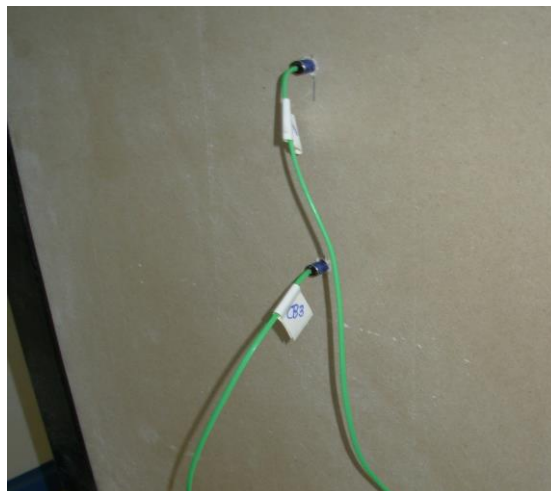
Σχήμα 3.17 Καλώδια θερμοστοιχείων στην εξωτερική πλευρά
