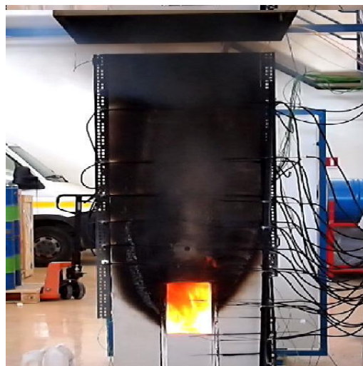
Σχήμα 4.87 Εξερχόμενη φλόγα, 60sec μετά την ανάφλεξη (Πείραμα Β7).
