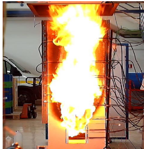
Σχήμα 4.15 Εξερχόμενη φλόγα, 240sec μετά την ανάφλεξη (Πείραμα A2).
