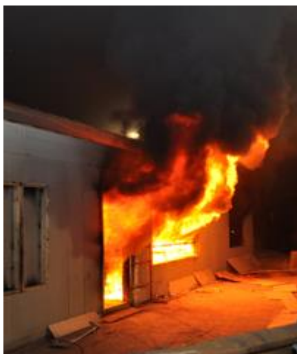
Σχήμα 1.2 Μετάβαση από το στάδιο ανάπτυξης της φωτιάς, στο στάδιο πλήρως αναπτυγμένης, μέσω της καθολικής ανάφλεξης.
