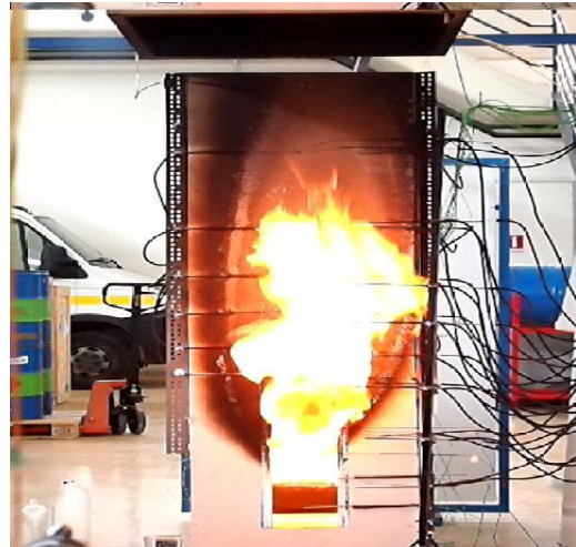
Σχήμα 4.13 Εξερχόμενη φλόγα, 120sec μετά την ανάφλεξη (Πείραμα A2).
