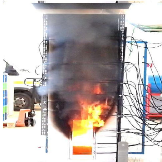
Σχήμα 4.79 Εξερχόμενη φλόγα, 60sec μετά την ανάφλεξη (Πείραμα Α6).
