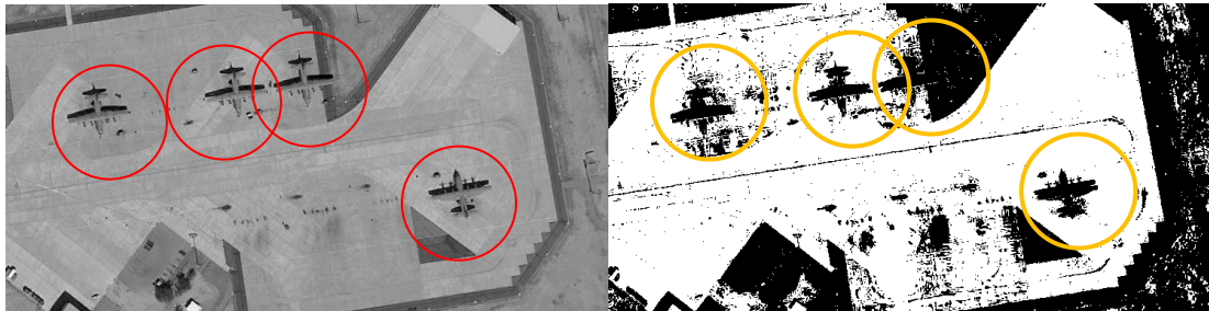
Εικόνα 27– Παράδειγμα εξασθένησης επιρροής background με την αφαίρεση επί της αρχικής εικόνας του Μ.Ο
