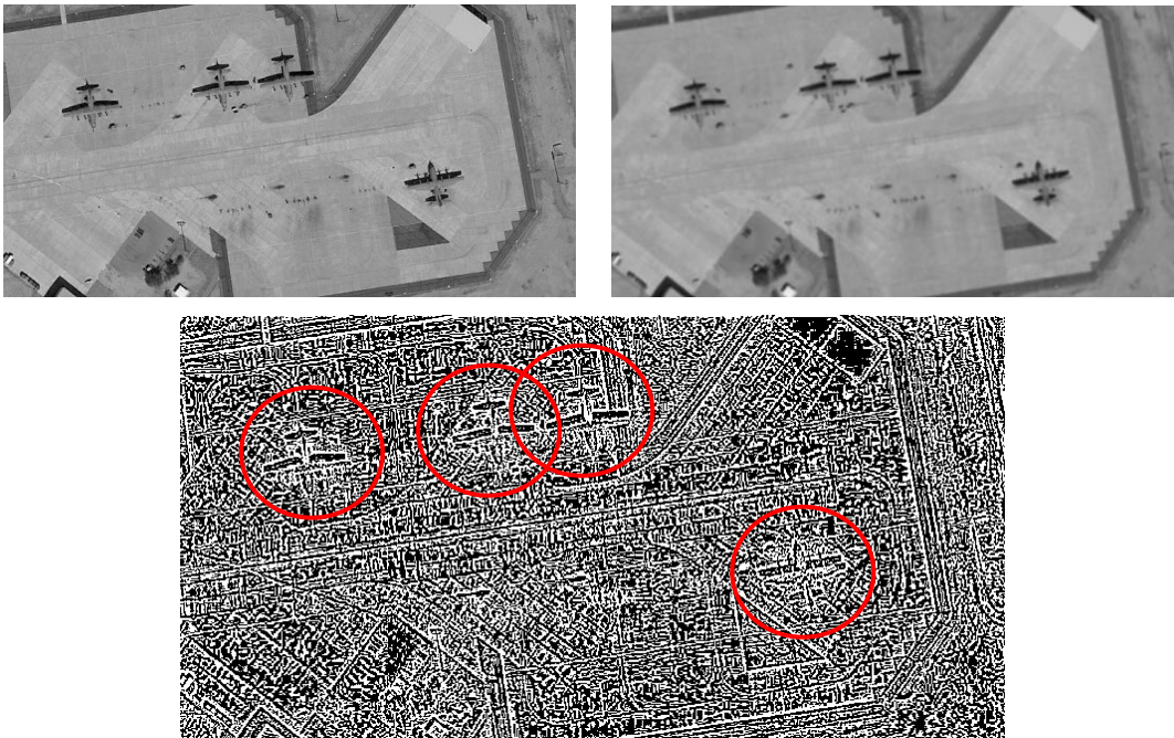
Εικόνα 28 - Παράδειγμα εξασθένησης επιρροής background με τη χρήση φίλτρου Gauss
