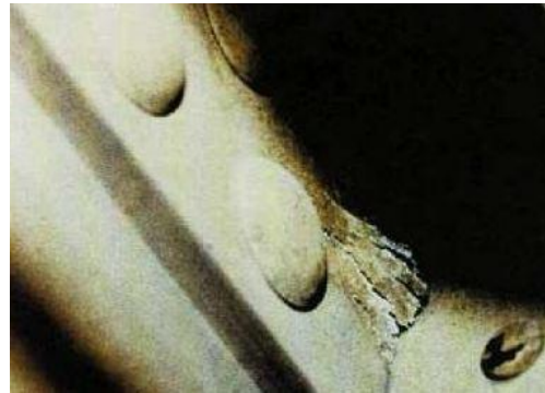
Εικόνα 1-7: Παράδειγμα διάβρωσης εξάνθησης
