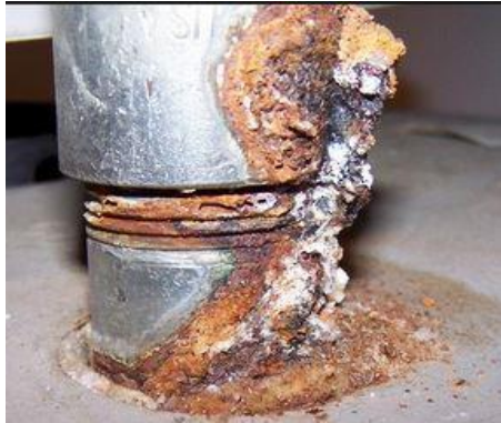
Εικόνα 1-8: Παράδειγμα γαλβανικής διάβρωσης
