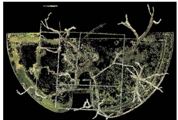
Εικ.21: Κάτοψη του σημειονέφους του δέντρου έπειτα από την απομόνωση των περιττών σημείων μέσα από το Cyclone.
