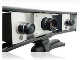
Εικ.14: Παράδειγμα σαρωτή τριγωνισμού. Αριστερά: (ΙΩΑΝΝΙΔΗΣ 2007-8), δεξιά: (φωτογραφία από www.directindustry.com )
