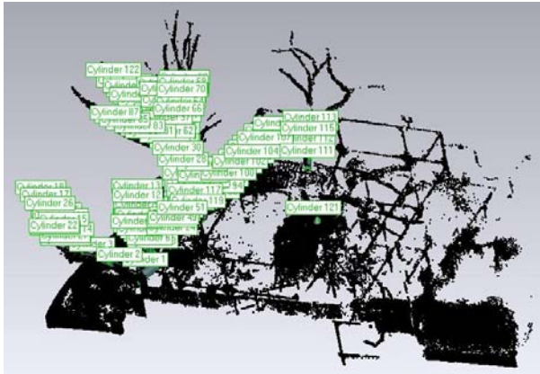
Εικ.24: Το μοντέλο, έπειτα από την εισαγωγή του στο Geomagic Studio και οι δημιουργημένοι κύλινδρος.
