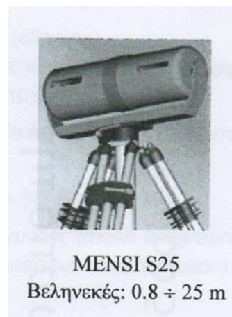
Εικ.13: Παράδειγμα σαρωτή μέτρησης διαφοράς φάσης. (ΙΩΑΝΝΙΔΗΣ 2007-8)
