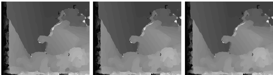
Σχήμα 6.94. Χάρτες παράλλαξης από εφαρμογή του κριτηρίου SAD (παράθυρο 15 \times 15 ) σε εικόνες που έχουν υποστεί μετασχηματισμό g_{\text{aff}} για παράθυρα: (α) 7 \times 7 , (β) 9 \times 9 , (γ) 11 \times 11 , (δ) 15 \times 15 , και εφαρμογή φίλτρων μεσαίας τιμής (μέσον) και μέσου όρου (δεξιά).
