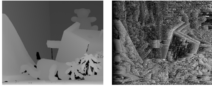
Σχήμα 6.115. Αληθούς χάρτης παράλλαξης (αριστερά) και χάρτης με βάση το κριτήριο των απόλυτων διαφορών (δεξιά).
