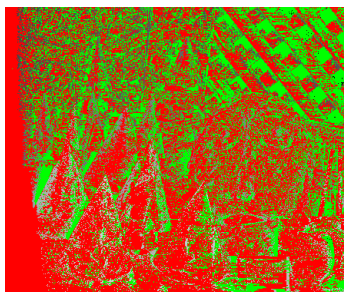
Σχήμα 6.57. Εικόνα διαφορών από τη σύγκριση του αληθούς χάρτη παράλλαξης με εκείνον από το κριτήριο των απόλυτων διαφορών.
