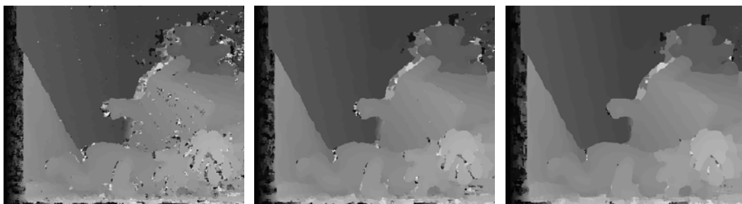
Σχήμα 6.82. Στερεοζεύγη εικόνων που προκύπτουν από το μετασχηματισμό rank για μέγεθος παραθύρου: (α) 7 \times 7 , (β) 9 \times 9 , (γ) 11 \times 11 , (δ) 15 \times 15 .
