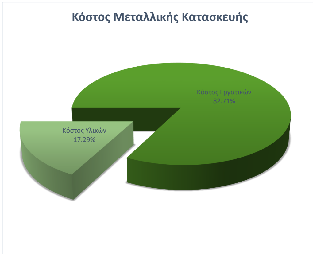
Διάγραμμα 10.1. Κόστος Μεταλλικής Κατασκευής
