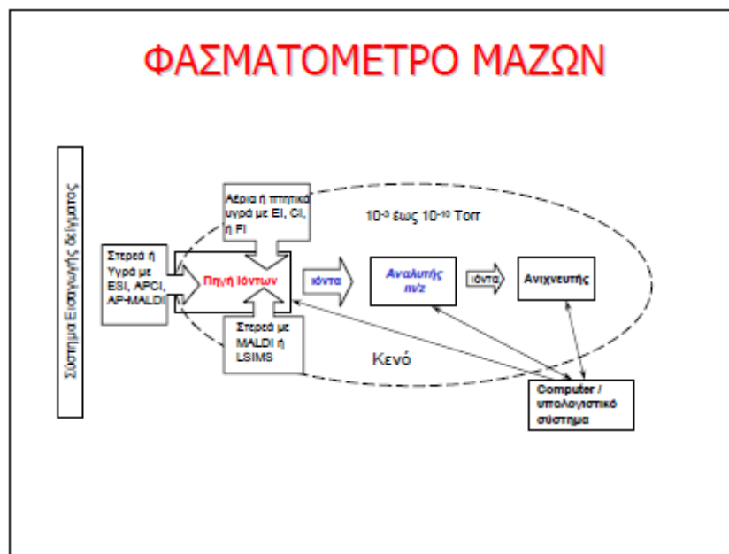
Εικόνα 2.7 Διάγραμμα ροής φασματομέτρου μαζών (Wiley et al. 2007)
