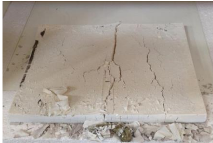
Εικόνα 4.56 Γυψοσανίδα με υλικά αλλαγής φάσης κατά την εξαγωγή των δοκιμίων από το πλαίσιο του φούρνου
