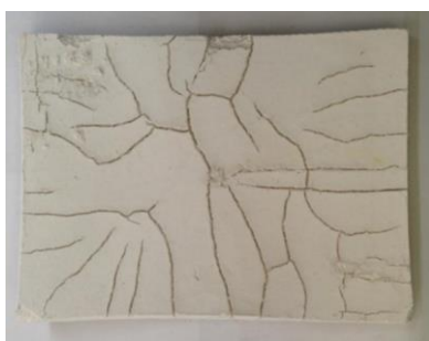
Εικόνα 4.54 Εσωτερική πλευρά γυψοσανίδας με υαλονήματα κατά την εξαγωγή των δοκιμίων από το πλαίσιο του φούρνου
