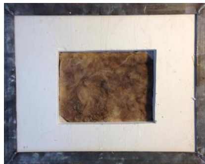
Εικόνα 3.41 Τοποθέτηση πετροβάμβακα στο κέντρο του πλαισίου
