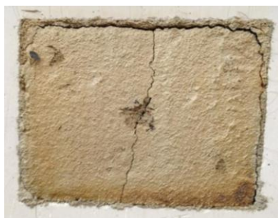
Εικόνα 4.52 Θερμοσοβάς κατά την εξαγωγή των δοκιμίων από το πλαίσιο του φούρνου
