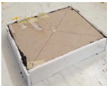
Εικόνα 3.32 Πλευρική μόνωση δοκιμίου με χρήση κεραμοκουβέρτας και κεραμικής πάστας
