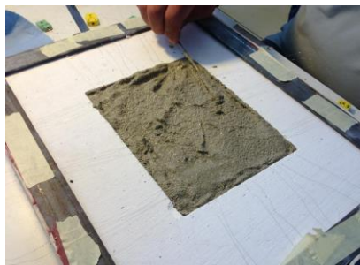
Εικόνα 3.44 Εφαρμογή θερμοσοβά με τη χρήση σπάτουλας
