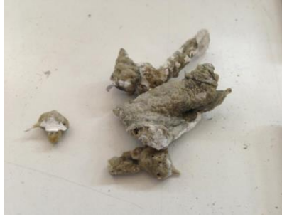
Εικόνα 4.55 Πετροβάμβακας κατά την εξαγωγή των δοκιμίων από το πλαίσιο του φούρνου
