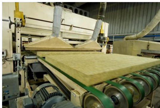
Εικόνα 2.10 Τεμαχισμός πλακών πετροβάμβακα στις απαιτούμενες διαστάσεις
