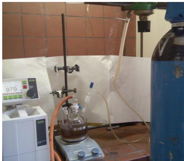
Σχήμα 5.2: Πειραματική διάταξη προς σύνθεση πολυεστεραμιδίων
