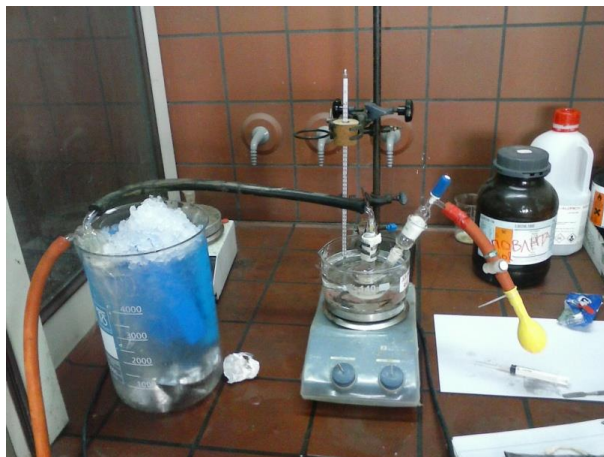
Σχήμα 6.1: Η πειραματική διάταξη παρασκευής PA 8,6 με τεχνική μάζας σε δύο στάδια
