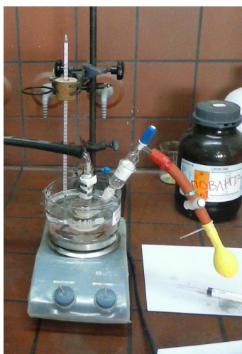
Σχήμα 5.1: Πειραματική διάταξη προς σύνθεση πολυαμιδίων
