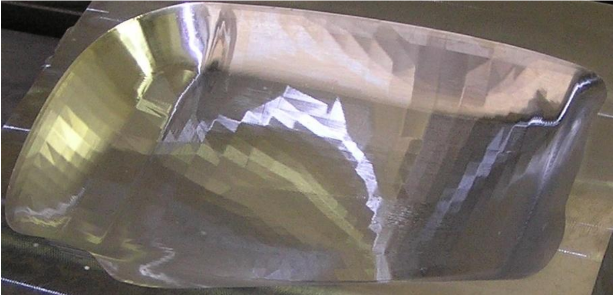
Εικ. 3. 25 Λεπτομέρεια του καλουπιού μετά το τέλος του φινιρίσματος με μεγάλες τιμές FT και TPT.
