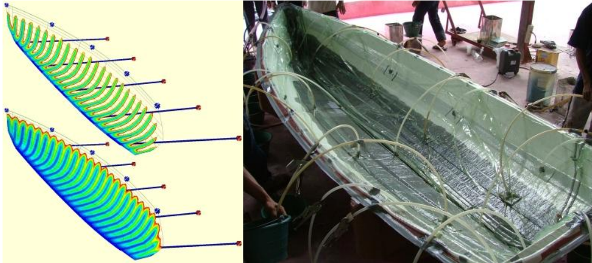
Εικ. 1.3 Αριστερά: Προσομοίωση διαβροχής κύτους σκάφους. Δεξιά: Διάταξη vacuum infusion σκάφους
