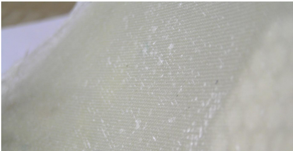
Εικ. 5.14 Λεπτομέρεια της επιφάνειας σε επαφή με το peel ply. Η ύφανση του έχει αποτυπωθεί πάνω στο πτερύγιο κάνοντάς την ακατάλληλη για χρήση σε υδροστρόβιλο χωρίς περαιτέρω επεξεργασία.
