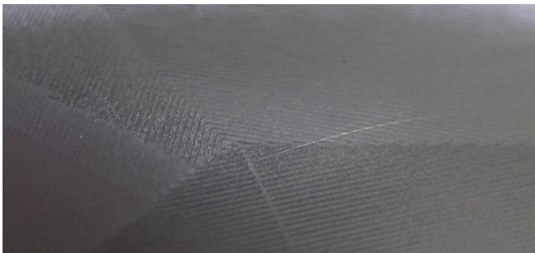
Εικ. 3. 27 Λεπτομέρεια από το κέντρο του καλουπιού όπου αποτυπώνεται η τροχιά του εργαλείου/
