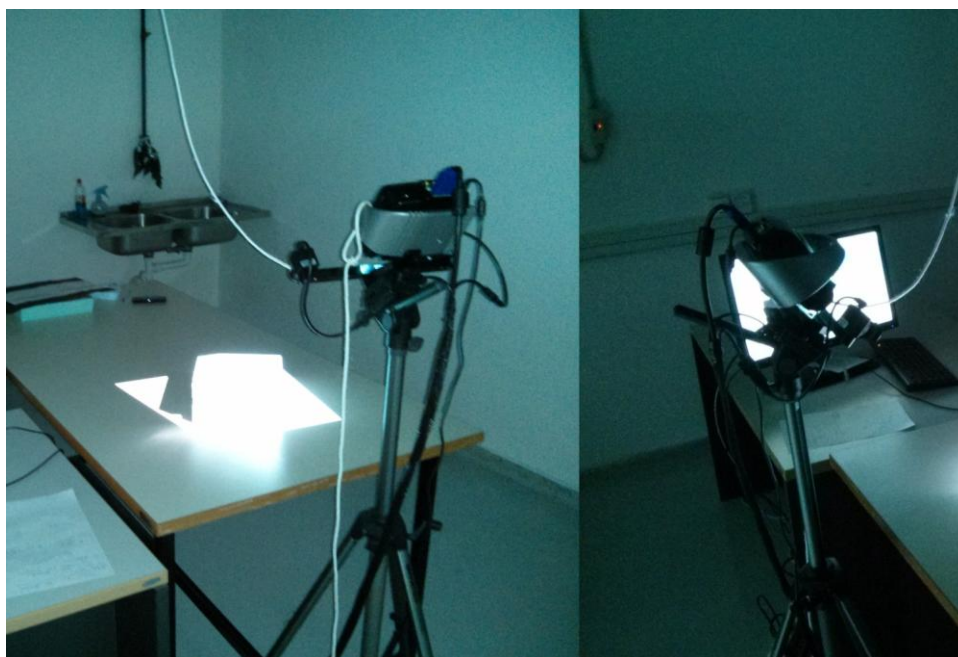
Εικ. 3.30 Το σύστημα ψηφιακής αποτύπωσης τεμαχίων με λευκό φως.
