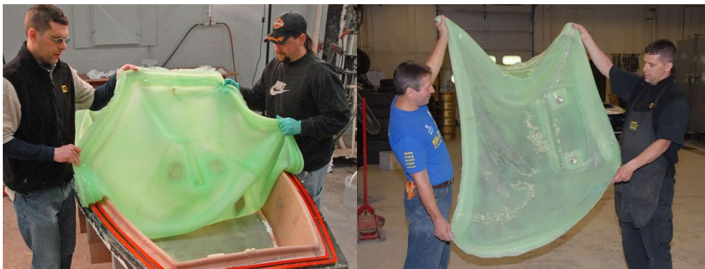
Εικ. 1.8 Επαναχρησιμοποιούμενη σιλικονούχα σακούλα. Φέρει ενσωματωμένες τις εισόδους, εξόδους και κανάλια ροής της ρητίνης. Το καλούπι ψεκάζεται με το σιλικονούχο υλικό το οποίο όταν στεγνώσει αποκολλάται και χρησιμοποιείται σαν σακούλα. [Smoothon.com]
