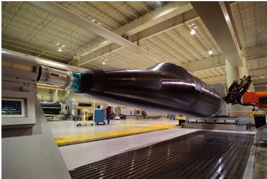
Εικ. 1.15 Διαδικασία παραγωγής AFP ατράκτου αεροσκάφους της εταιρεία Hawker Beechcraft.
