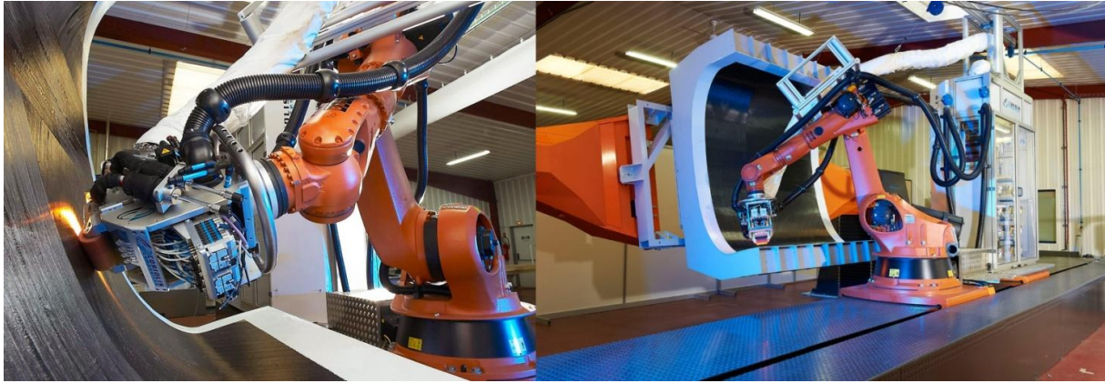
Εικ. 1.14 AFP/ATP με ρομποτικούς βραχίονες του εμπορίου στους οποίους εφαρμόζονται κεφαλές κατάλληλες για τον τύπο της κάθε εφαρμογής. Μπορούν να χρησιμοποιηθούν με πρόσθετους άξονες γραμμικής μετακίνησης των ρομποτικών βραχιόνων και περιστροφικούς για τα καλούπια [Coriolis]
