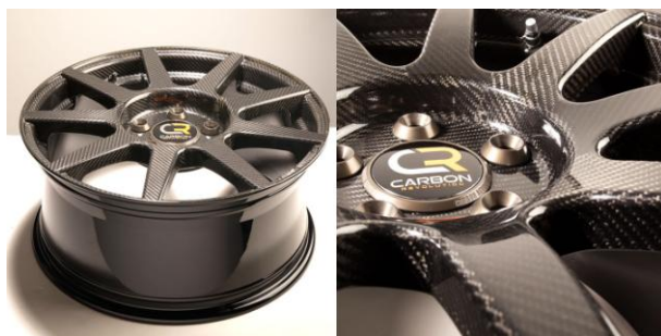
Εικ. 1.2 Τροχός αυτοκινήτου παραγόμενος με μέθοδο υγρής ρητίνης. Τεχνολογική πρωτοπορία αποτελεί η παραγωγή του σαν ένα κομμάτι (monocoque).
