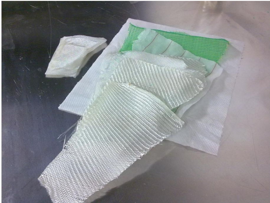
Εικ. 5.5 Υφάσματα, reel ply(ύφασμα με κόκκινες λωρίδες), flow medium (πράσινο ύφασμα) και τα τμήματα του πυρήνα αριστερά με τα μικρά κομμάτια υφάσματος που τον καλύπτουν.
