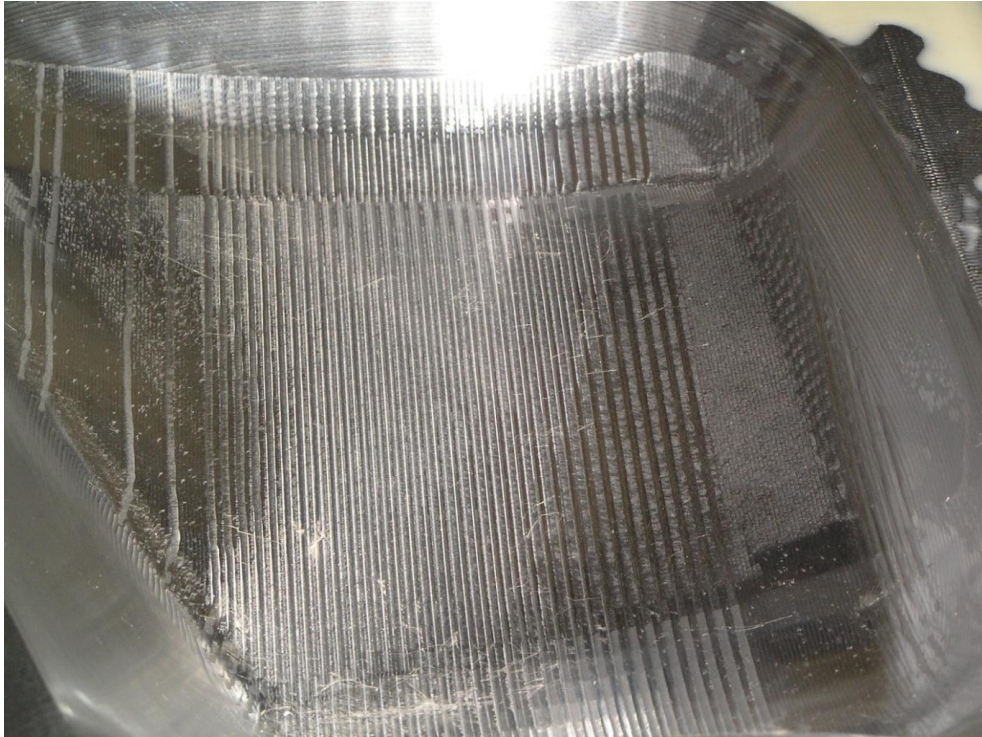
3. 23 Διαφορετική άποψη της προβληματικής επιφάνειας του καλουπιού της Εικ. 3.22.
