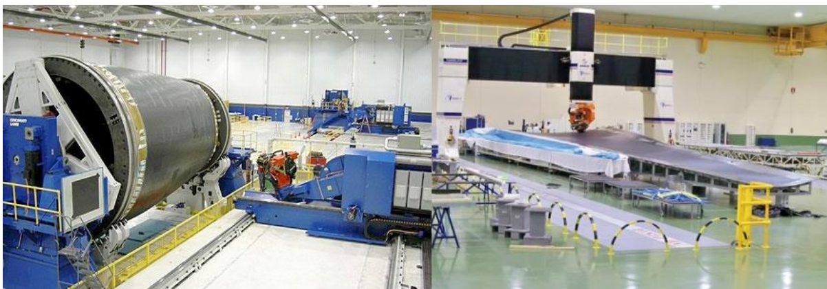
Εικ. 1.13 Πολύ μεγάλες μηχανές AFP/ATP για την κατασκευή ατράκτου και φτερού αεροσκάφους.
