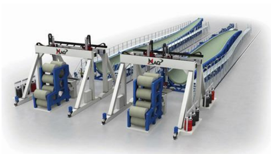
Εικ.1.17 Προσπάθεια της εταιρείας MAG για ανάπτυξη νέου τύπου μηχανών/λογισμικού για τοποθέτηση στεγνών υφασμάτων. Στο ίδιο κελί η τύπου gantry μηχανή θα κόβει και θα τοποθετεί κομμάτια υφάσματος αφού έχει ψεκάσει το καλούπι με gel coat, ενώ μετά τη διαδικασία του infusion θα τοποθετεί συγκολλητικές ουσίες για την συναρμολόγηση του κομματιού.
