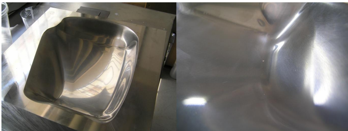
Εικ. 3.29 Το σιλβωμένο καλούπι. Τα σημάδια από την κοπή έχουν εξαφανιστεί χωρίς όμως το καλούπι να έχει όψη καθρέφτη. Δεξιά: Λεπτομέρεια του καλουπιού
