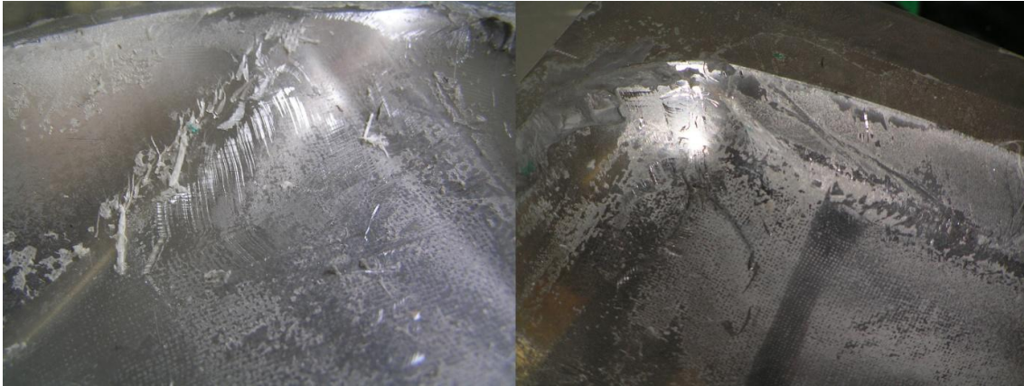
Εικ. 5.10 Κατά την αποκόλληση του πτερυγίου από το καλούπι χρειάστηκε να δημιουργηθεί μοχλός ανάμεσα στο πτερύγιο και το καλούπι ώστε να απομακρυνθούν. Το εργαλείο που χρησιμοποιήθηκε ήταν ακατάλληλο και άφησε επιφανειακά σημάδια στο καλούπι, κάτι το οποίο θα ήταν ανεπίτρεπτο σε καλούπι παραγωγικής διαδικασίας.
