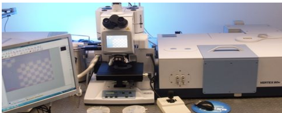
Εικόνα 4.4.2-1: Ειδικό φασματοσκόπιο για το χαρακτηρισμό του εύρους φάσματος απορρόφησης σε φωτοβολταϊκά στοιχεία νανοδομών [90].
