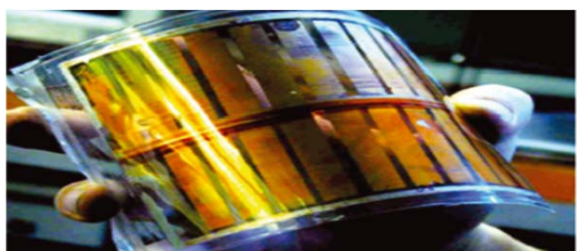
Εικόνα 4.4.1-2: Οργανικό φωτοβολταϊκό στοιχείο [83].
