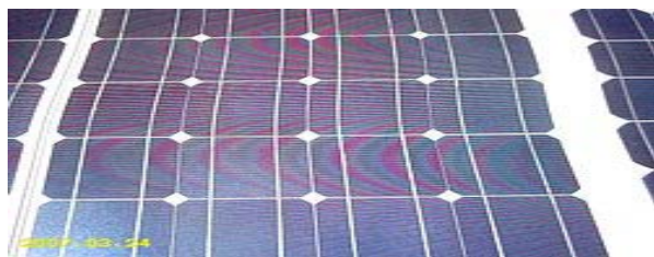
Εικόνα 4.1.1-1: Φωτοβολταϊκό πλαίσιο από μονοκρυσταλλικό πυρίτιο [53].
