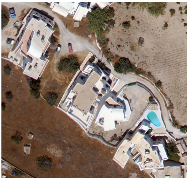
Εικόνα 6-6: Παραμορφώσεις σε ορθοφωτογραφία, λόγω σφαλμάτων DTM (μη συλλογή γραμμών αλλαγών κλίσεων) στην περιοχή της Ν. Σαντορίνης
