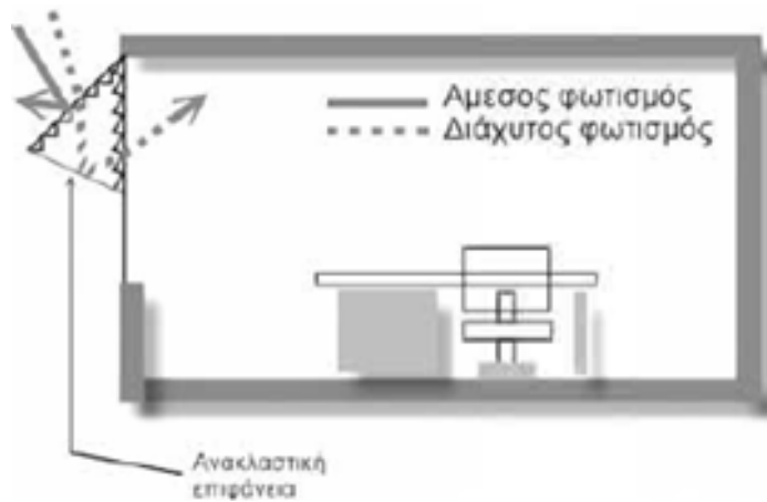
Εικ.4.32 Πρισματικό σύστημα φωτισμού 16
