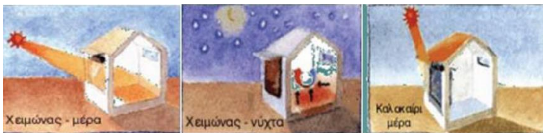
Εικ.1.6 Τρεις βασικές αρχές του βιοκλιματικού σχεδιασμού: απρόσκοπτη είσοδος της ηλιακής ακτινοβολίας κατά τη διάρκεια της χειμερινής ημέρας και διατήρηση της θερμότητας αυτής το βράδυ και επαρκής προστασία από τις ηλιακές ακτίνες το καλοκαίρι 18
