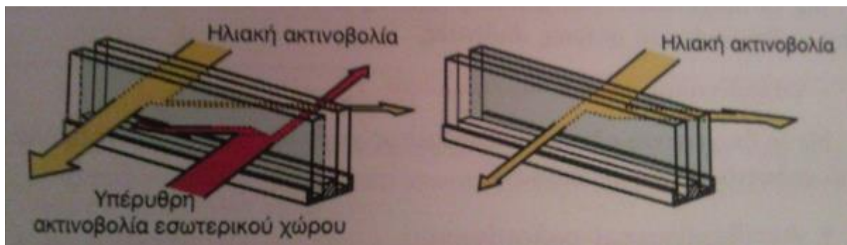
Εικ.4.35 Υαλοπίνακες χαμηλού συντελεστή θερμικής ακτινοβολίας (Low-e) 18
