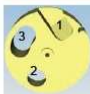
Εικόνα 1.5: Ο δίσκος 3 θέσεων του System Analyser [Leica TPS 1200 + White Paper]
