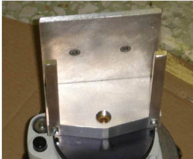
Εικόνα 1.11: Η ειδικά κατασκευασμένη βάση στήριξης που χρησιμοποιήθηκε για την τοποθέτηση των δοκιμίων.
