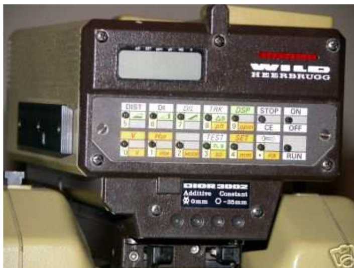
Εικόνα 1.2: Το αποστασιόμετρο Wild DIOR 3002S. Η πρώτη διάταξη με δυνατότητα μέτρησης χωρίς ανακλαστήρα [http://www.bujorel.com/id2.html]
