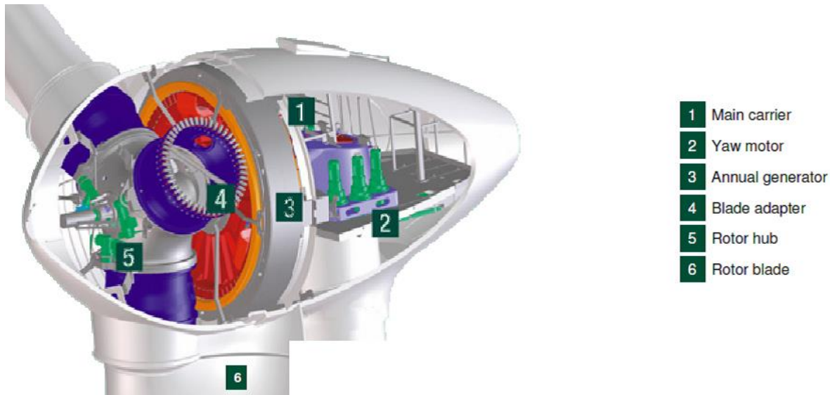
Εικόνα 6-3: Συστατικά μέρη ανεμογεννήτριας (Πηγή: Enercon)
