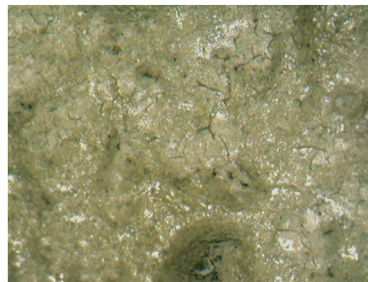
Σχ. 6.2.26. Κρακελαρίσματα (×30) σε μαύρο κύριας επιφάνειας
