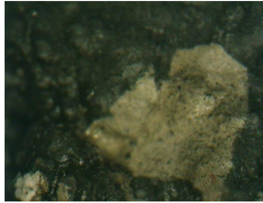
Σχ.6.2.19. Αποκόλληση (×30) φωτογραφικού στρώματος
