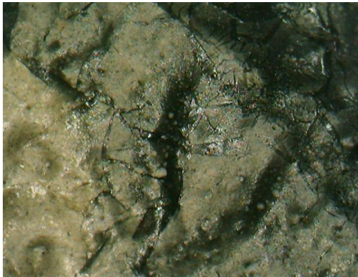
Σχ. 6.2.26. Κρακελαρίσματα (×30) σε μαύρο κύριας επιφάνειας
