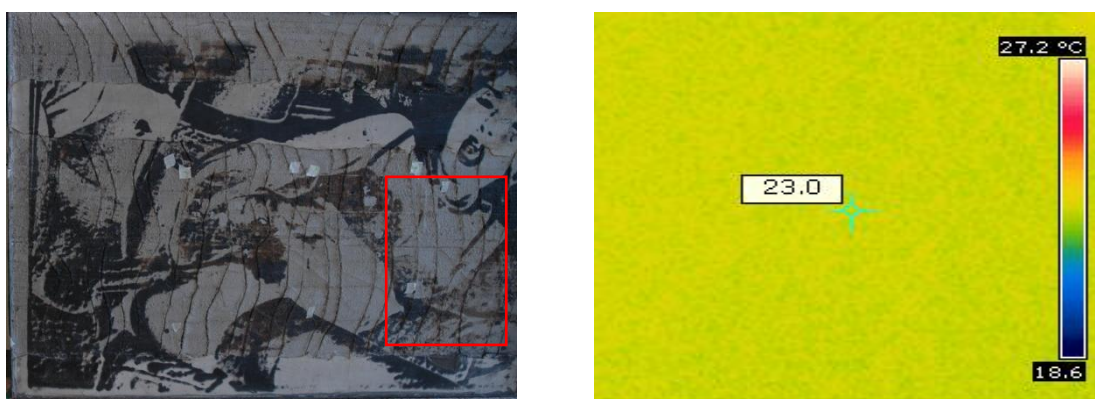
Σχ. 8.2.2. Θερμογράφημα σε απόσταση κάμερας, d_{cam} = 1,07m
