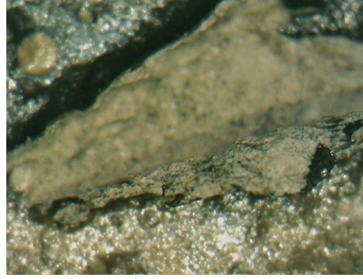
Σχ. 6.2.22. Ξεφλούδισμα (x30) φωτογραφικού γαλακτώματος
