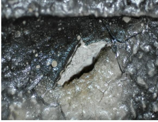
Σχ.5.2.10. Εεφλούδισμα φωτογραφικού στρώματος με macromode φακό Nikon
