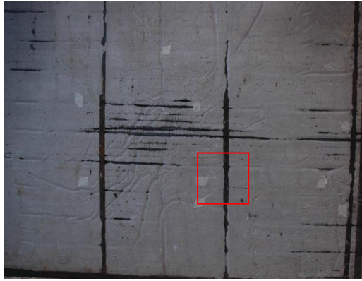
Σχ. 8.2.5. Κάθετος σπλισμός σε απόσταση κάμερας, d_{cam} = 28cm
