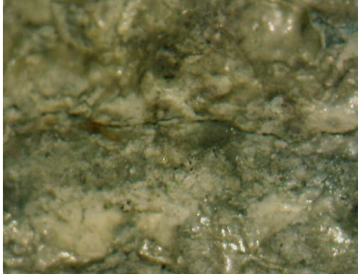
Σχ. 6.2.9. Ρωγμή (×30) στην κύρια επιφάνεια
