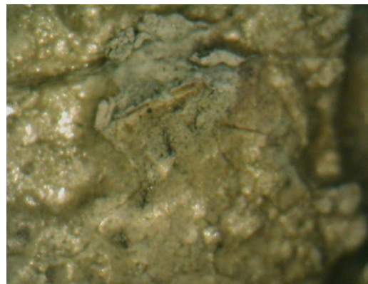
Σχ. 6.2.21. Αποκόλληση (×30) φωτογραφικού στρώματος
