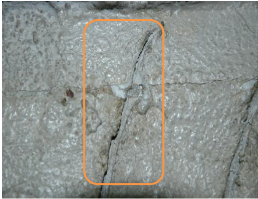
Σχ.5.2.6. Καμπύλη χάραξη κύριας επιφάνειας έργου με πραγματικό μάκρο - φακό (micro - Nikkor len)
