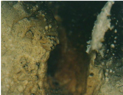
Σχ. 6.2.23. Ξεφλούδισμα (x30) φωτογραφικού γαλακτώματος
