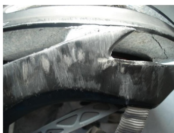
Εικόνα 27: Ξεθωριασμένο κέλυφος σε συνδυασμό με ρωγμές στην επένδυση
