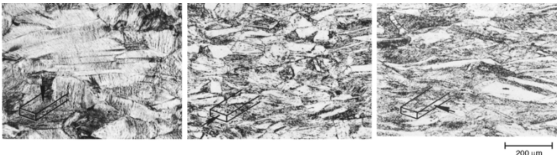
Σχήμα 1.23: Ίδιο κράμα και επεξεργασία όπως στο σχήμα 1.22, αλλά μειωμένο κατά 50% με ψυχρή έλαση από τις 6 mm (0,239 ίντσες) στις 3 mm (0,120 in). Οι κόκκοι επιμηκύνονται στην κατεύθυνση έλασης. Διαγράμματα δείχνουν ίδιο προσανατολισμό της αποψησότητας στο σχήμα 1.22. Χαραγμένο με \text{NH}_4\text{OH} και \text{H}_2\text{O}_2 . 75 x. [8]
