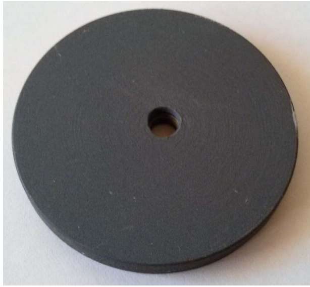
Σχήμα 3.33: Δοκίμιο Ε, δίσκος χάλυβα με επικάλυψη
