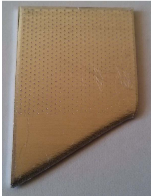
Σχήμα 3.37: Δοκίμιο Η, έλασμα αλουμινίου μετά από αστοχία σε εφελκυσμό
