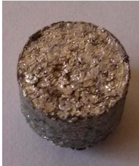
Σχήμα 3.59: Δοκίμιο Μ μερικής πίεσης σκόνης χαλκού στα 40 kN
