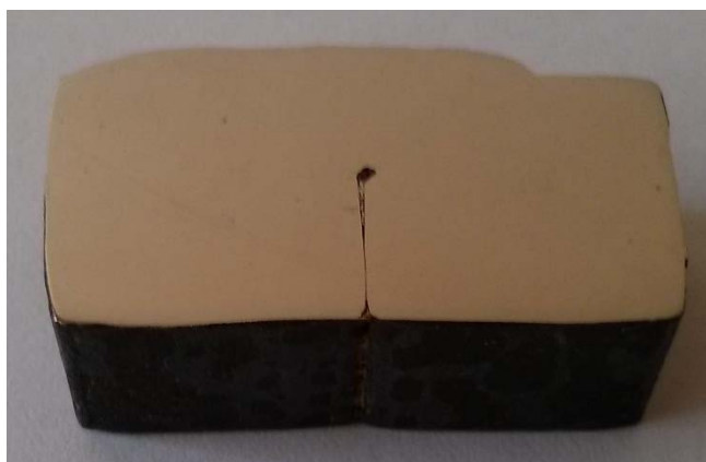
Σχήμα 3.25: Δοκίμιο Δ από χάλυβα μετά από συγκόλληση σε εγκάρσια τομή
