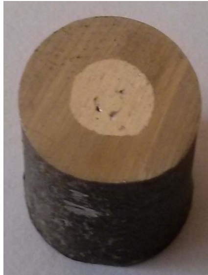
Σχήμα 3.65: Δοκίμιο Ο εκρηκτικής συμπίεσης σε εγκάρσια τομή
