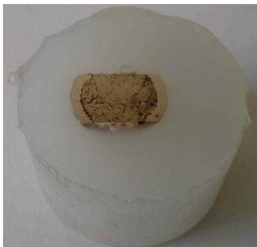
Σχήμα 3.1: Δοκίμιο Α εκρηκτικής συμπίεσης σε κάθετη τομή
