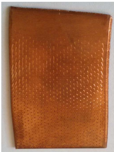
Σχήμα 3.39: Δοκίμιο Θ έλασμα χαλκού μετά από αστοχία σε εφελκυσμό
