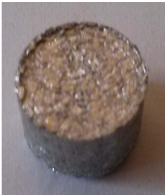
Σχήμα 3.61: Δοκίμιο Ν μερικής πίεσης σκόνης χαλκού στα 70 kN
