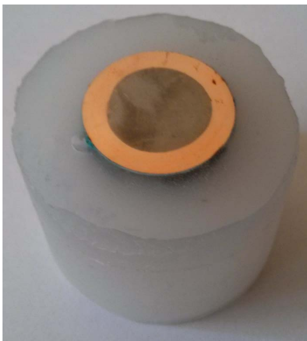
Σχήμα 3.51: Δοκίμιο Λ διμεταλλικό με αλουμίνιο και χαλκό σε εγκάρσια τομή
