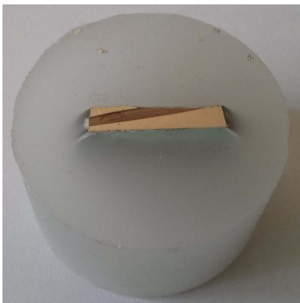
Σχήμα 3.17: Δοκίμιο Γ συμπίεσης σκόνης χαλκού σε δίσκο σε κάθετη τομή
