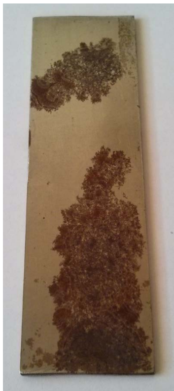
Σχήμα 3.35: Δοκίμιο Ζ οξειδωμένο χαλύβδινο δοκίμιο
