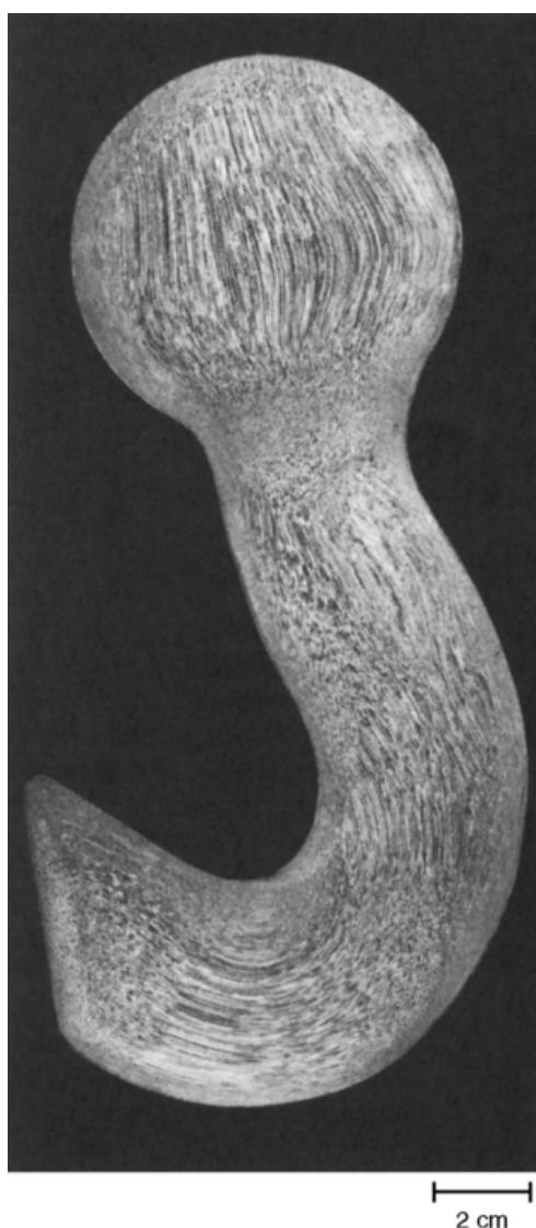
Σχήμα 1.6: Γραμμές ροής σε σφυρήλατο 4140 γάντζο από χάλυβα. Το δείγμα χαραχθηκε χημικά χρησιμοποιώντας 50% HCl. 0.5x. [8]
