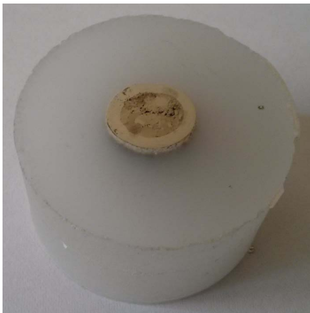
Σχήμα 3.9: Δοκίμιο Β εκρηκτικής συμπίεσης σε εγκάρσια τομή
