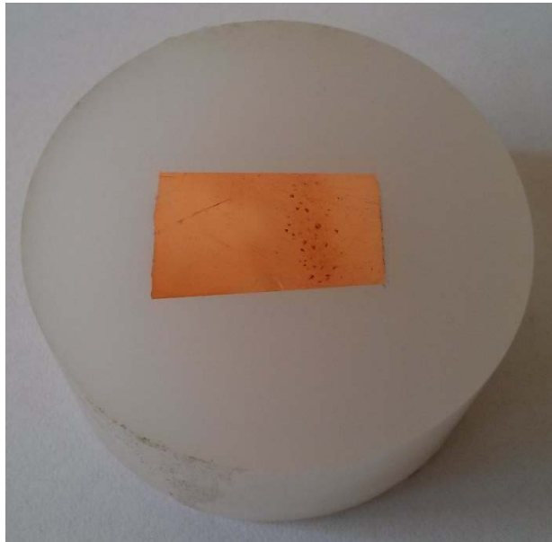
Σχήμα 3.43: Δοκίμιο Κ εγκιβωτισμένου χαλκού σε εγκάρσια τομή
