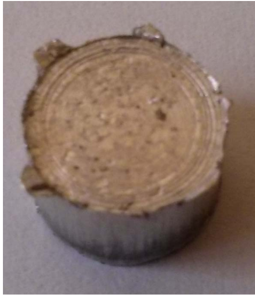
Σχήμα 3.63: Δοκίμιο Ξμερικής πίεσης σκόνης χαλκού στα 90 kN
