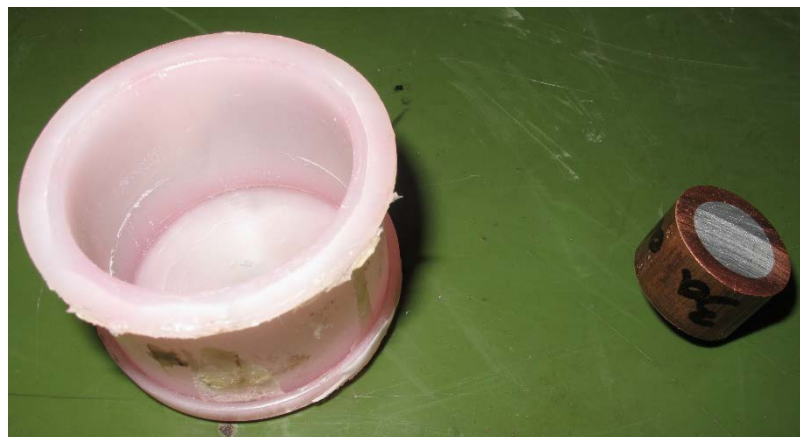
Σχήμα 2.4: Ειδικό κουτί εγκιβωτισμού δοκίμιο προς εγκιβωτισμό
