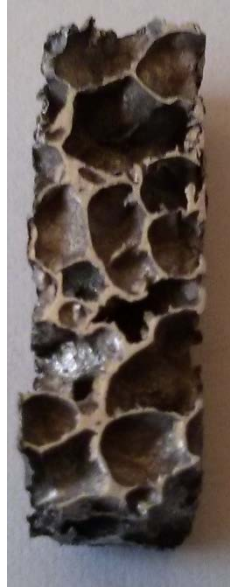
Σχήμα 3.41: Δοκίμιο Ι μεταλλικού αφρού από αλουμίνιο
