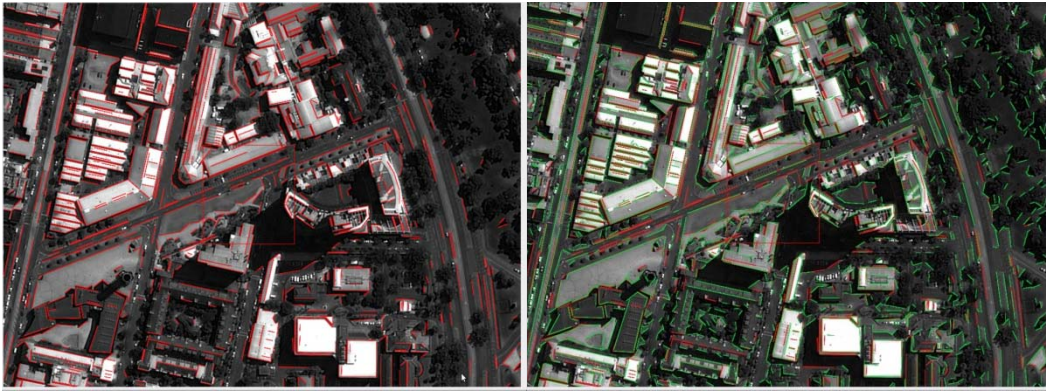
Εικόνα 4.41: Αριστερά: Αποτέλεσμα εφαρμογής LSD στο εικονιζόμενο οδικό δίκτυο στο κόκκινο κανάλι της εικόνας της Μελβούρνης. Δεξιά: Αποτέλεσμα εφαρμογής του LSD έπειτα από επεξεργασία της αρχικής εικόνας με το φίλτρο Gauss. Με πράσινο χρώμα αποδίδονται οι γραμμές που ανιχνεύτηκαν στην εξομαλυμένη και με κόκκινο εκείνες στην αρχική μη επεξεργασμένη εικόνα του κόκκινου καναλιού.
