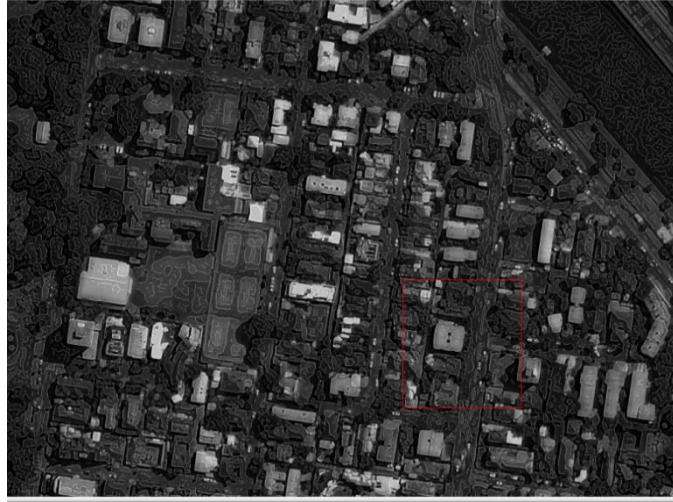
Εικόνα 4.76: Αποτέλεσμα εφαρμογής αλγορίθμου Canny σε εικονιζόμενες περιοχές αστικής δόμησης στο κόκκινο κανάλι της εικόνας της Μελβούρνης (δεύτερη αντιπροσωπευτική περιοχή της εικόνας).
