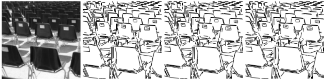
Εικόνα 2.21: Αποτέλεσμα εφαρμογής αλγορίθμου LSD για εικόνα για τρεις διαφορετικές τιμές της παραμέτρου \epsilon (από αριστερά προς τα δεξιά) \epsilon = 1 , \epsilon = 10^{-1} και \epsilon = 10^{-2}
