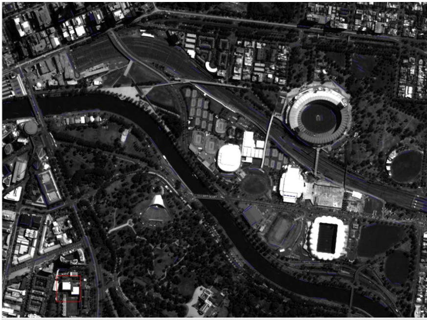
Εικόνα 4.24: Αποτέλεσμα εφαρμογής του αλγορίθμου LSD σε πυραμίδα εικόνων στο κόκκινο κανάλι της εικόνας της Μελβούρνης (πρώτο απόσπασμα της εικόνας). (Παρόν μέγεθος εικόνας: 1024x1024, αρχικό μέγεθος εικόνας: 4096x4096)
