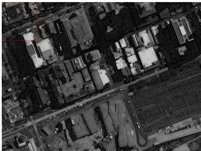
Εικόνα 4.75: Αποτέλεσμα εφαρμογής αλγορίθμου Canny σε εικονιζόμενες περιοχές αστικής δόμησης στο κόκκινο κανάλι της εικόνας της Μεμβούρνης (πρώτη αντιπροσωπευτική περιοχή της εικόνας).
