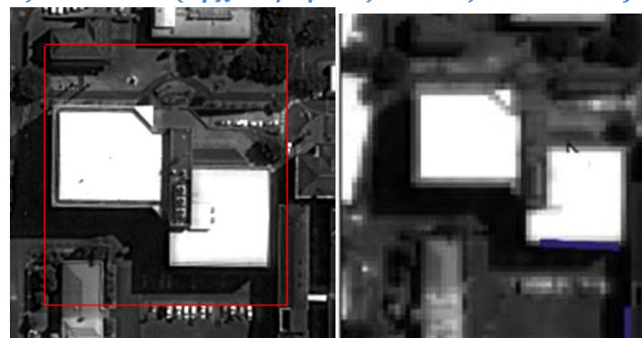
Εικόνα 4.28: Αποτέλεσμα εφαρμογής αλγορίθμου LSD στην εικόνα της Μελβούρνης διαστάσεις εικόνας 1024x1024 (αρχικό μέγεθος εικόνας: 4096x4096). Στην εικόνα εμφανίζεται αντιπροσωπευτική περιοχή αστικής δόμησης.
