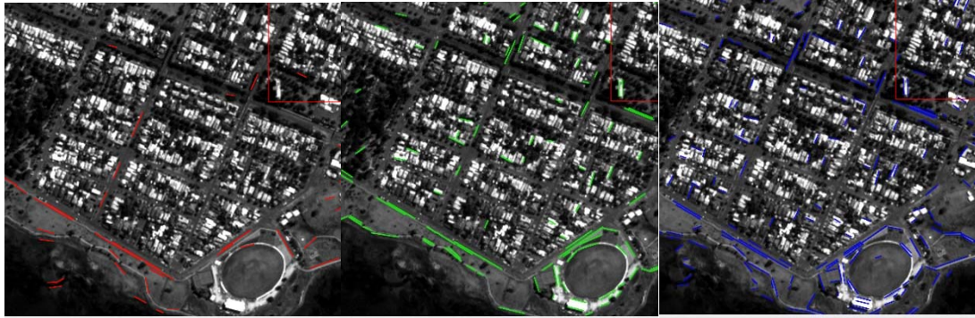
Εικόνα 5.18: Αποτέλεσμα εφαρμογής LSD στα τρία επίπεδα μελέτης (πρώτη αντιπροσωπευτική περιοχή αστικής δόμησης).
