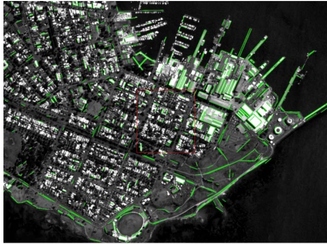
Εικόνα 5.16: Αποτέλεσμα εφαρμογής αλγορίθμου LSD στο δεύτερο επίπεδο μελέτης (δεύτερη αντιπροσωπευτική περιοχή αστικής δόμησης).
