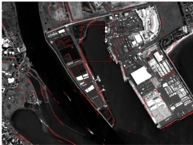
Εικόνα 5.12: Αποτέλεσμα εφαρμογής LSD στο πρώτο επίπεδο μελέτης (πρώτη αντιπροσωπευτική περιοχή αστικής δόμησης).
