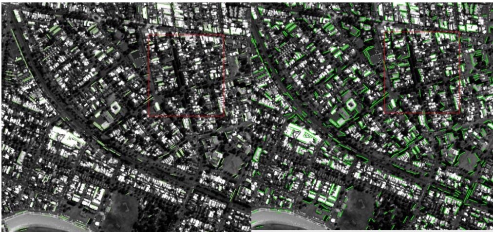
Εικόνα 5.21: Αριστερά: Αποτέλεσμα εφαρμογής αλγορίθμου LSD στο επίπεδο των τεσσάρων τμημάτων για την αρχική εικόνα (πρώτη αντιπροσωπευτική περιοχή αστικής δόμησης). Δεξιά: Αποτέλεσμα εφαρμογής αλγορίθμου LSD στο επίπεδο των τεσσάρων τμημάτων για την εξομαλυμένη εικόνα.
