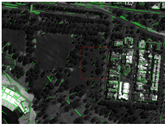
Εικόνα 5.10: Αποτέλεσμα εφαρμογής αλγορίθμου LSD στο δεύτερο επίπεδο μελέτης. Απόσπασμα εικόνας στο οποίο εμφανίζονται υπαίθριοι χώροι.
