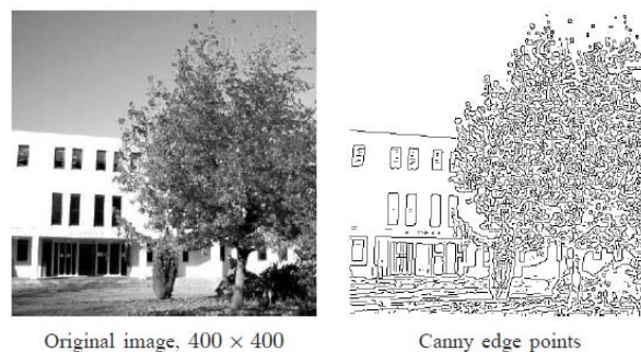
Εικόνα 2.1: Εφαρμογή ανίχνευσης ακμών μέσω του φίλτρου Canny
