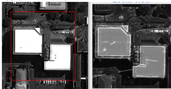
Εικόνα 4.81: Αριστερά: Αποτέλεσμα εφαρμογής του LSD Δεξιά: Αποτέλεσμα εφαρμογής μετασχηματισμού Hough. Στην εικόνα εμφανίζεται αντιπροσωπευτική περιοχή αστικής δόμησης.
