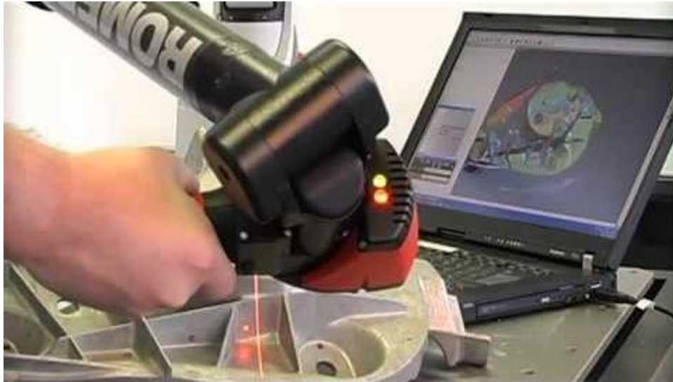
Εικόνα 5.1: 3D Laser Scanner σε διαδικασία σάρωσης
