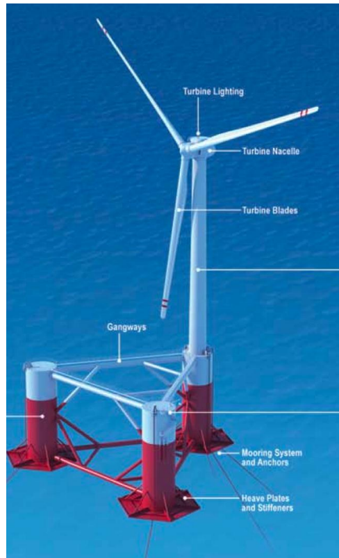
Εικόνα 1.28: Απεικόνιση της πλατφόρμας WindFloat [48]
