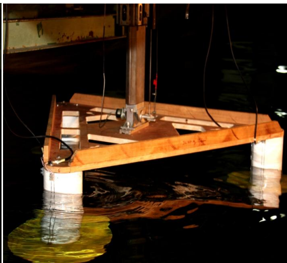
Εικόνα 3.5: Το μοντέλο δεμένο στο δυναμόμετρο R47
