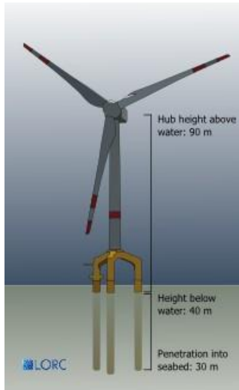
Εικόνα 1.14: Κατασκευή στήριξης τριπλού πυλώνα – Tripile [29]
