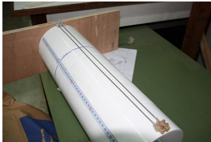
Εικόνα 3-6: Wave probes τοποθετημένα στον απλό κύλινδρο
