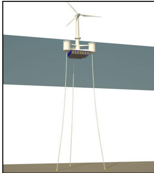
Εικόνα 1.27: Πλωτή ημιβυθισμένη κατασκευή στήριξης ανεμογεννήτριας
