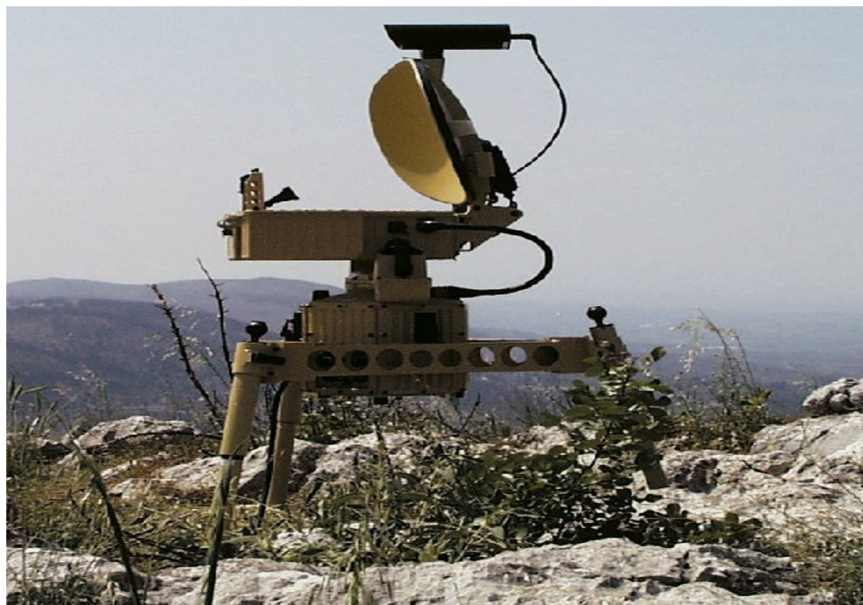
Σχήμα 2.2 Ραντάρ χαμηλής πιθανότητας υποκλοπής (BOR-A 550)
