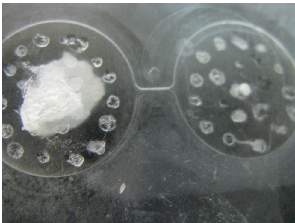
Εικόνα 22 επιτυχής σφράγιση αριστερά, ασθενής δεξιά , στο ίδιο κύκλωμα
