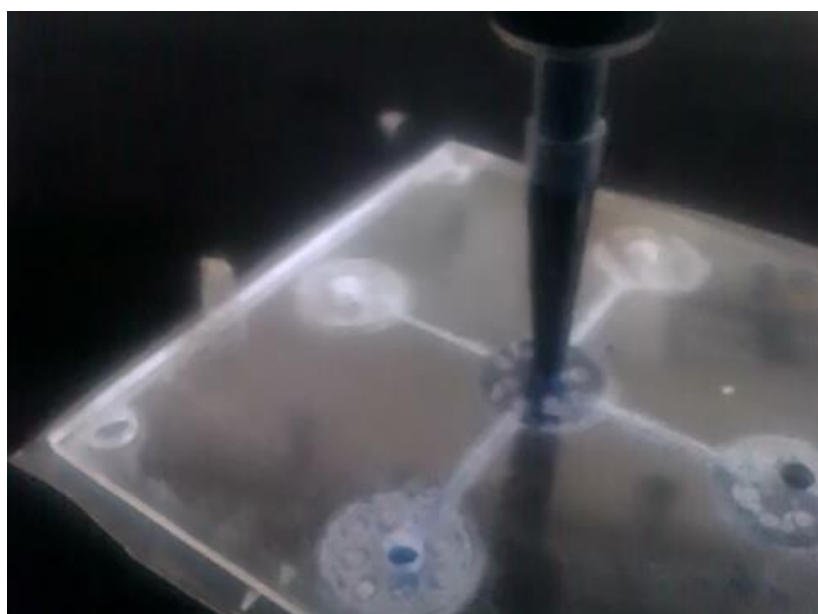
Εικόνα 2 υγρό διαρρέει την βαλβίδα διατομής 50μm (13mbar)
