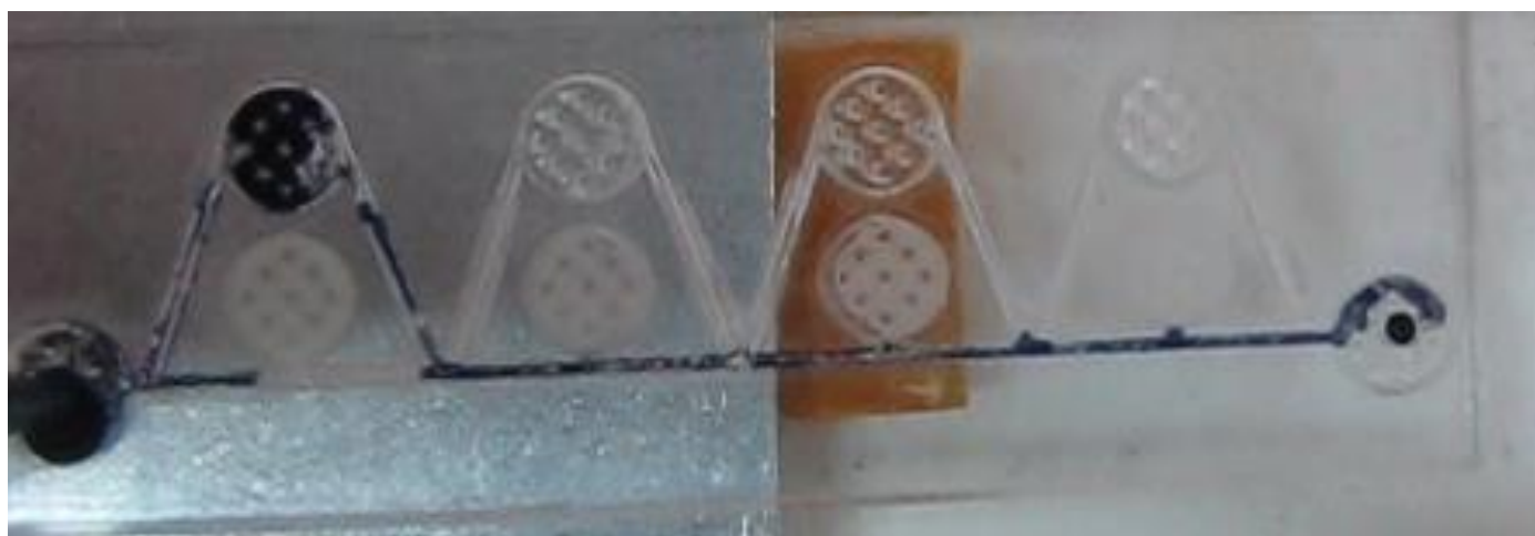
Εικόνα 31 από τον θάλαμο φύλαξης οδηγείτε στο θάλαμο αντιδράσεων χωρίς να διαταράσσονται οι υπόλοιποι θάλαμοι
