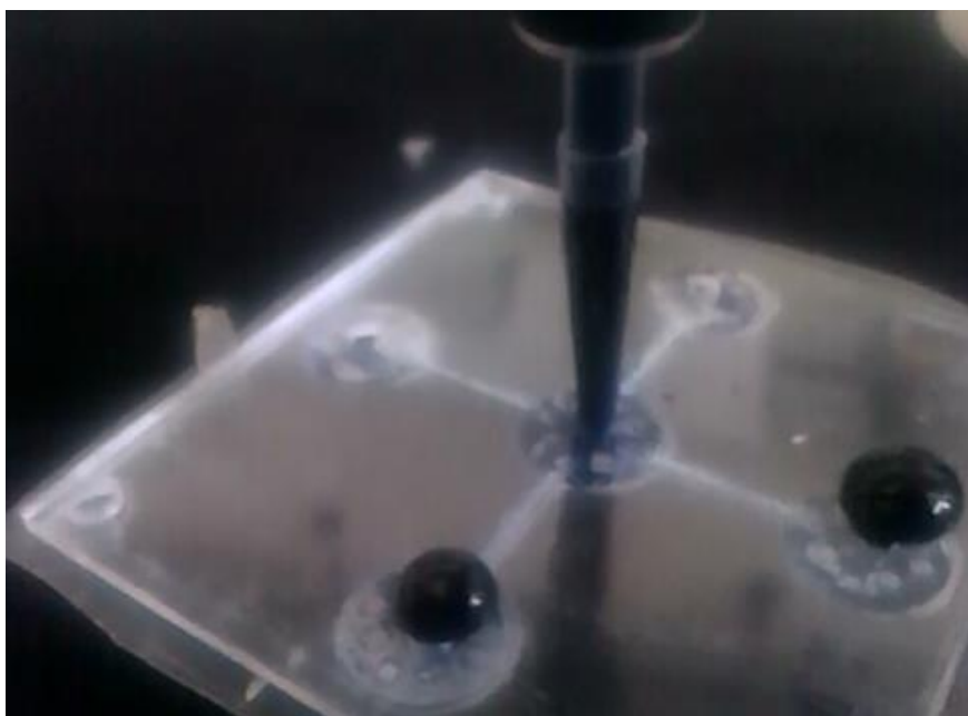
Εικόνα 4 υγρό διαρρέει όλες της βαλβίδες (20mbar)
