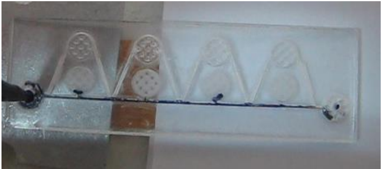
Εικόνα 28 αρχικά υγρό δεν διέρχεται από κανένα θάλαμο
