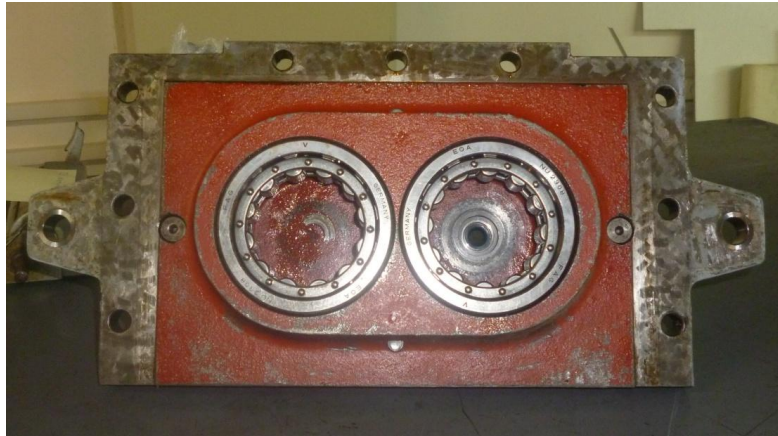
Σχήμα 3-4: Το πρώτο κομμάτι του κιβωτίου που εδράζει τα γρανάζια 3-4
