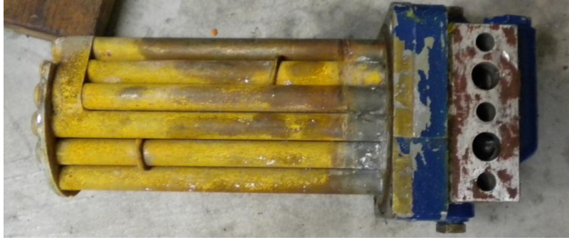
Σχήμα 3-14: Το εσωτερικό κομμάτι του εναλλάκτη θερμότητας
