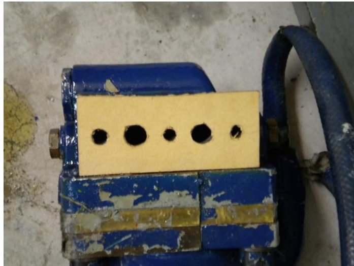
Σχήμα 3-16: Ο εναλλάκτης με την καινούρια φλάντζα
