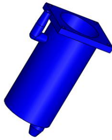
Σχήμα 4.28: Εναλλάκτης θερμότητας λαδιού-νερού, μέρος β
