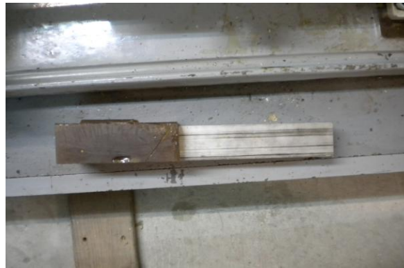
Σχήμα 5.4: Αυτοσχέδιο εργαλείο κομμάτι αλουμινίου και ρητίνης
