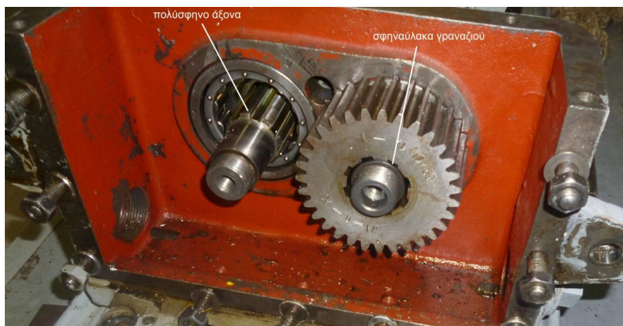
Σχήμα 3-7: Φαίνονται τα πολύσφηνα που έχουν οι άξονες καθώς και σφηνάλακες των γραναζιών
