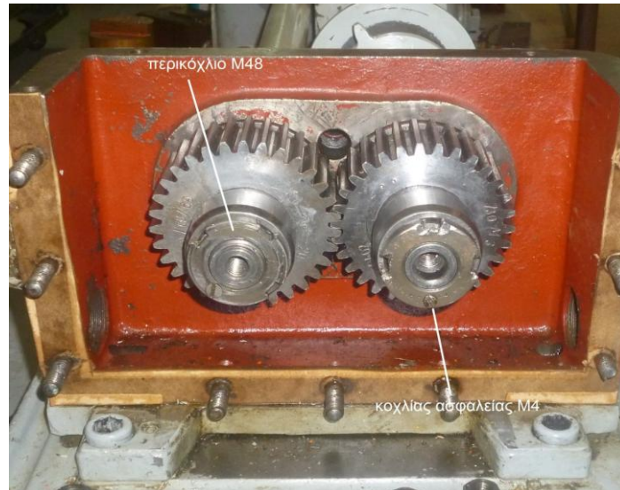
Εικόνα 3-5: Παρουσιάζονται το περικόχλιο M48 και ο κοχλίας ασφαλείας M4
