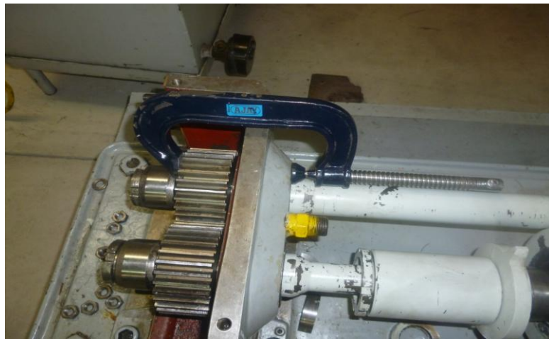
Σχήμα 5.5: Η μέγγενη που τοποθετήθηκε σαν "κόντρα"
