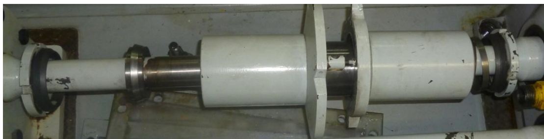
Σχήμα 3-9: Σύνδεσμος που βρίσκεται πάνω στην άτρακτο 2
