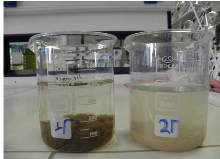
Εικόνα 40: Αποτελέσματα απομάκρυνσης χρωμίου, καδμίου και χαλκού με χρήση διαλύματος διθειοκαρβαμιδικού πολυμερούς, κροκιδωτικού και πολυηλεκτρολύτη (Σειρά 1: στο αρχικό διάλυμα περιέχεται εξασθενές χρώμιο, Σειρά 2: στο αρχικό διάλυμα περιέχεται τρισθενές χρώμιο)
