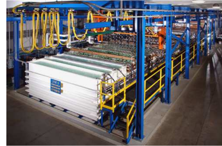
Εικόνα 2: Γραμμή επιμεταλλώσεων με μεταφορικές ταινίες (EC, 2006)
