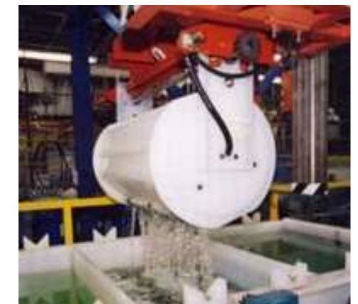
Εικόνα 4: Βαρέλι σε λειτουργία (EC, 2006)
