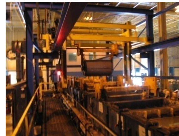
Εικόνα 3: Γραμμή επιμεταλλώσεων με βαρέλια (EC, 2006)
