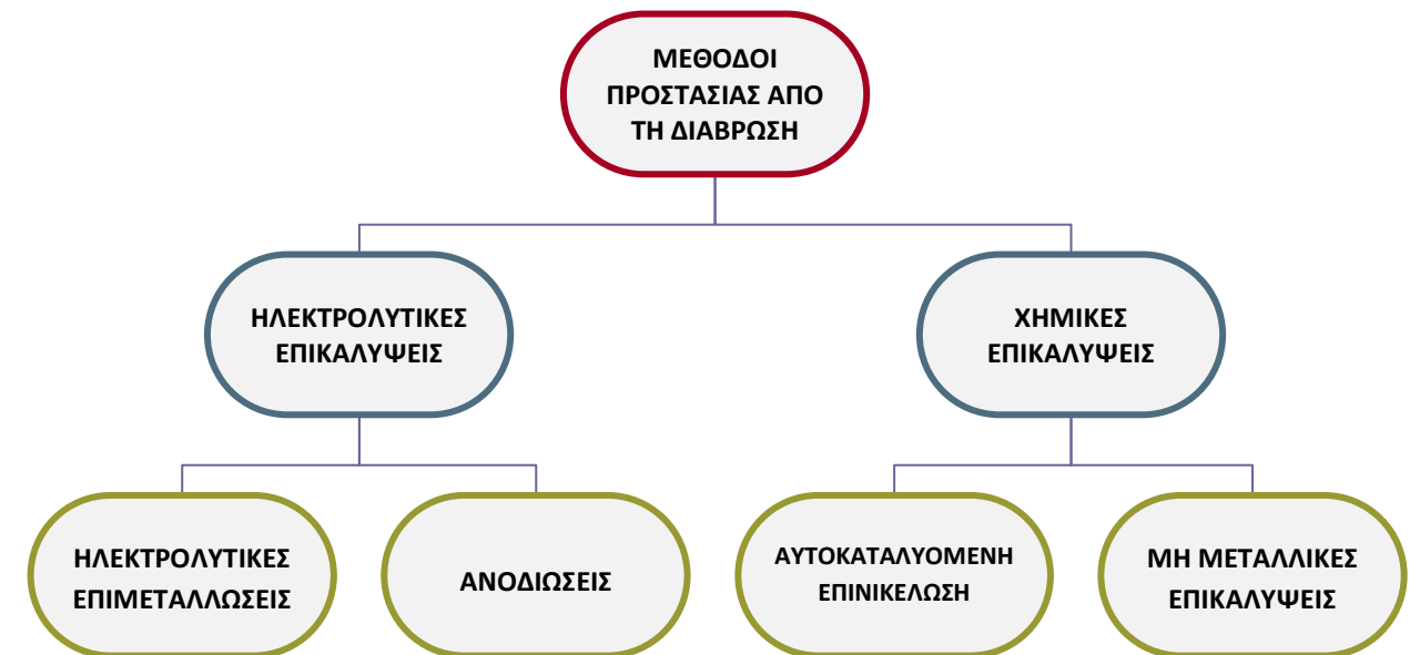
Εικόνα 6: Μέθοδοι προστασίας από τη διάβρωση
