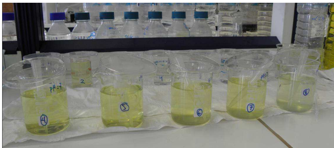
Εικόνα 22: Μελέτη αναγωγής διαλύματος εξασθενούς χρωμίου σε pH 7
