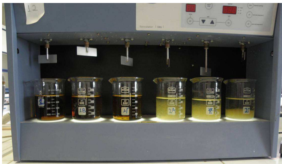
Εικόνα 36: Συστήματα συνθετικού διαλύματος Cr [ως Cr(VI) και ως Cr(III)], Cd, Cu 5mg/L μετά την προσθήκη πολυμερούς
