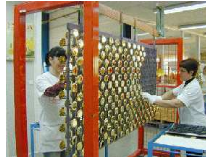
Εικόνα 1: Τοποθέτηση εξαρτημάτων σε πλαίσια στήριξης (EC, 2006)
