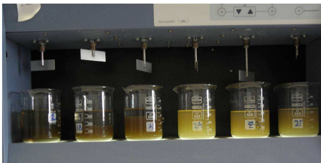
Εικόνα 38: Συστήματα συνθετικού διαλύματος Cr, Cd, Cu 5mg/L μετά την προσθήκη διαλύματος διθειοκαρβαμιδικού πολυμερούς και PACl
