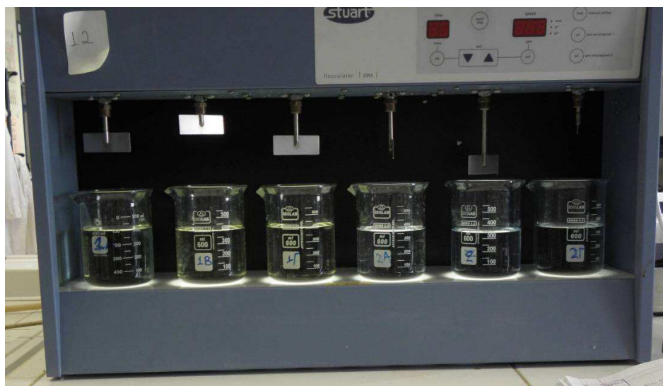
Εικόνα 35: Αρχικά συστήματα συνθετικού διαλύματος Cr [ως Cr(VI) και ως Cr(III)], Cd, Cu 5mg/L
