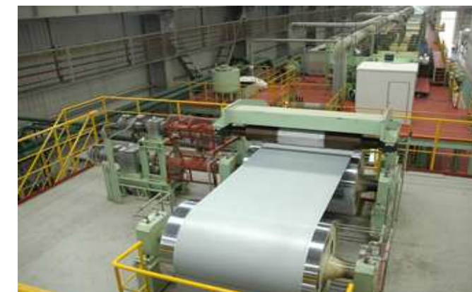
Εικόνα 5: Γραμμή εισαγωγής ρολών προς επιμετάλλωση (EC, 2006)
