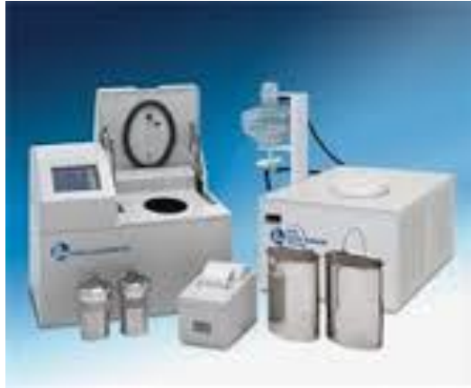
Σχήμα 1.2: Εξοπλισμός που χρησιμοποιείται για τις δοκιμές του προσδιορισμού της θερμαντικής αξίας, EN ISO 1716.
