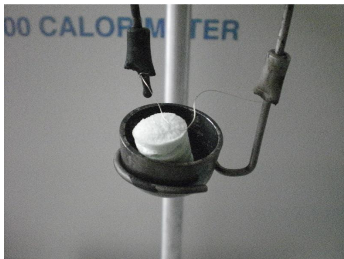
Σχήμα 3.19: Τοποθέτηση του σύρματος ανάφλεξης.
