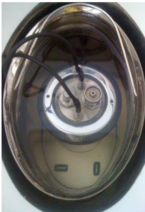
Σχήμα 3.12: Τοποθέτηση της οβίδας και εισαγωγή των ηλεκτροδίων.
