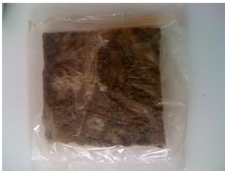
Σχήμα 4.10: Τοποθέτηση μονωτικού υλικού σε πλαστική μεμβράνη.
