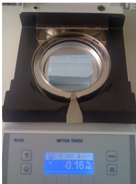
Σχήμα 3.28: Αφύγρανση της εξηλασμένης πολυστερίνης.
