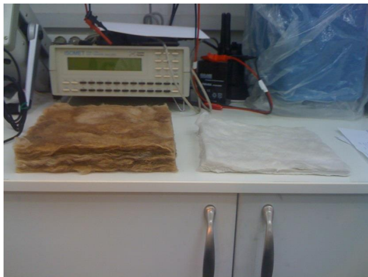
Σχήμα 4.16: Σύγκριση πετροβάμβακα σε συνθήκες περιβάλλοντος (αριστερά) και πετροβάμβακα στους 600°C (δεξιά).
