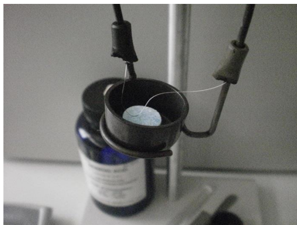
Σχήμα 3.30: Τοποθέτηση του σύρματος ανάφλεξης.
