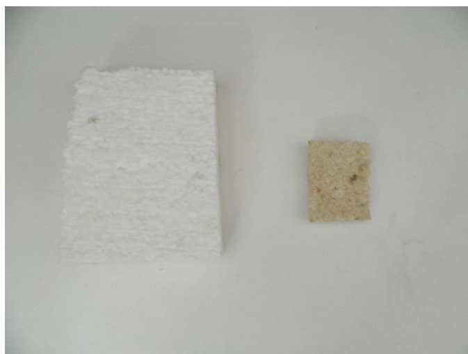
Σχήμα 4.38: Αλλαγή μεγέθους διογκωμένης πολυστερίνης στους 150°C.
