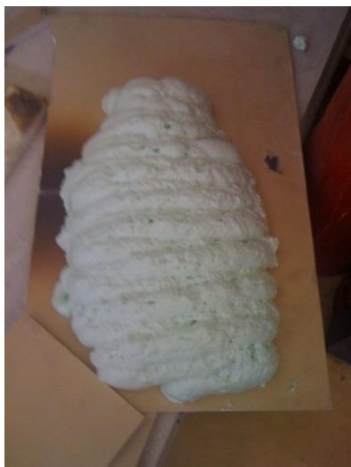
Σχήμα 3.16: Αφρός πολυουρεθάνης κατά τη διάρκεια της διόγκωσης και στερεοποίησης.
