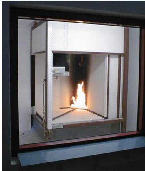
Σχήμα 1.4: SBI δοκιμή, φωτογραφία κατά τη διάρκεια της δοκιμής, EN 13823.
