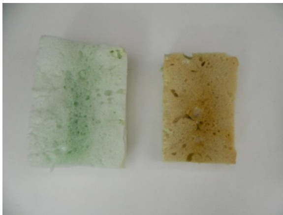
Σχήμα 4.14: Αλλαγή χρώματος αφρού πολυουρεθάνης στους 150°C.
