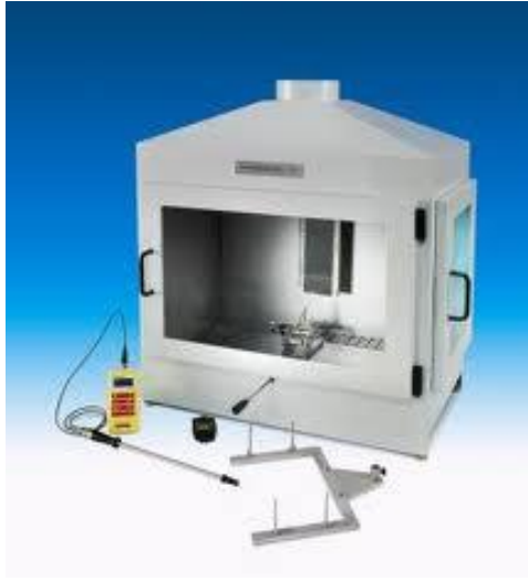
Σχήμα 1.5: Εξοπλισμός που χρησιμοποιείται για τις δοκιμές της αναφλεξιμότητας, EN ISO 11925-2.
