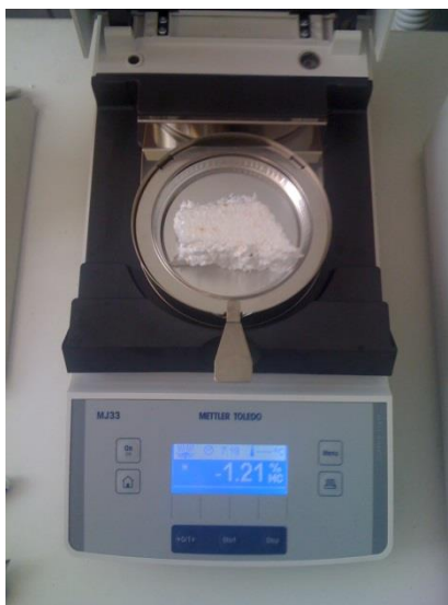
Σχήμα 3.33: Αφύγρανση της διογκωμένης πολυστερίνης.
