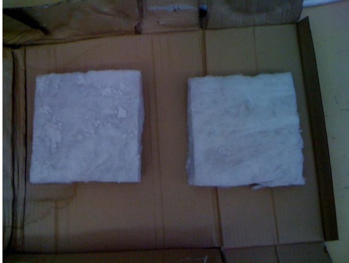
Σχήμα 4.14: Αλλαγή χρώματος πετροβάμβακα.
