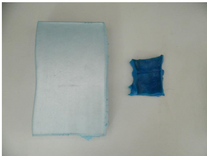
Σχήμα 4.32: Συρρίκνωση εξηλασμένης πολυστερίνης στους 150°C.
