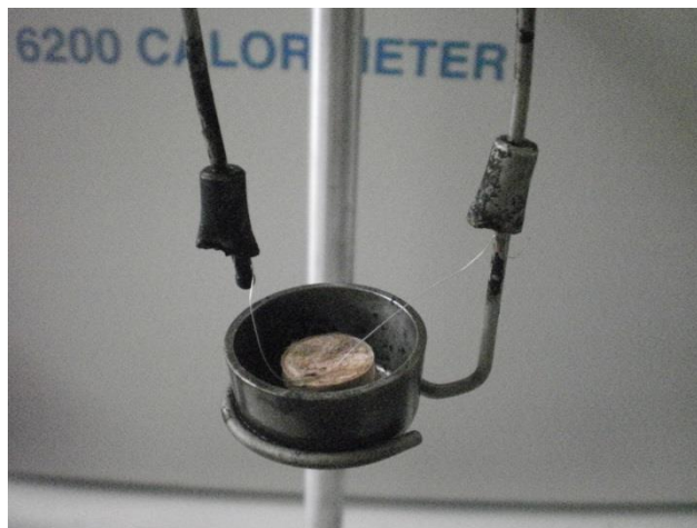
Σχήμα 3.24: Τοποθέτηση του σύρματος ανάφλεξης.
