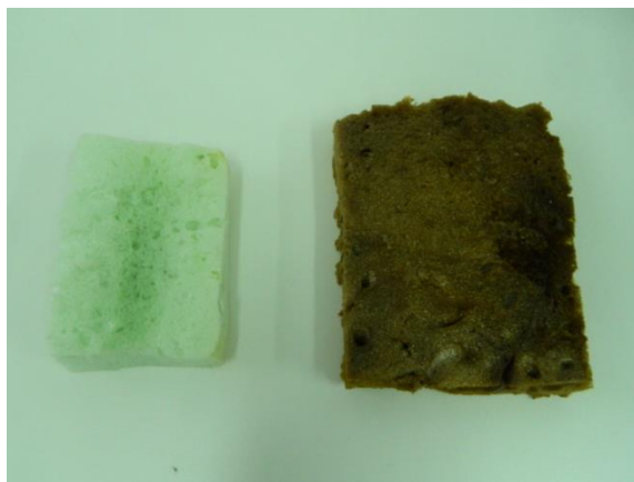
Σχήμα 4.15: Αλλαγή χρώματος αφρού πολυουρεθάνης στους 200°C.
