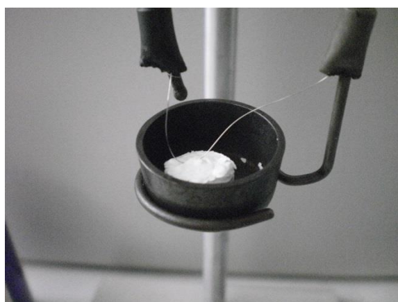
Σχήμα 3.35: Τοποθέτηση του σύρματος ανάφλεξης.
