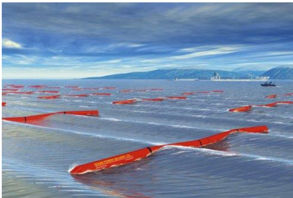
Σχήμα 3.6.6: Σχέδιο διάταξης συγκομιδής της κυματικής ενέργειας με χρήση διηλεκτρικών ελαστομερών.
