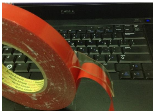
Σχήμα 4.1.2 φιλμ VHB 4910 της 3M και το HM 1100C της IMTX
