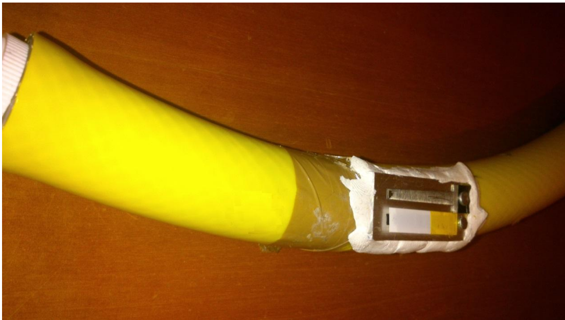
Σχήμα 8.32: Πειραματική διάταξη γλωττίδας – βάσης στήριξης προσαρμοσμένη πάνω κυλινδρικού αγωγού
