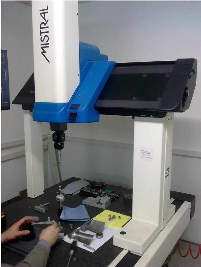
**Σχήμα 8.7** Χρήση CMM εργαστηρίου για την ακριβή μέτρηση των διαστάσεων
