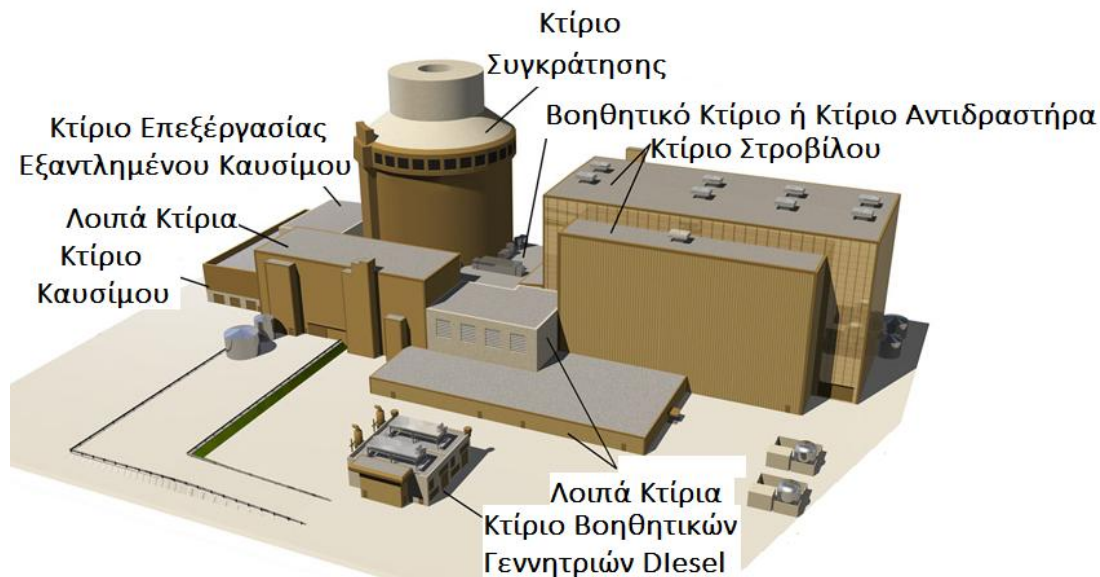
Εικόνα 37: Απλοποιημένη ενδεικτική διάταξη πυρηνικού σταθμού [42]
