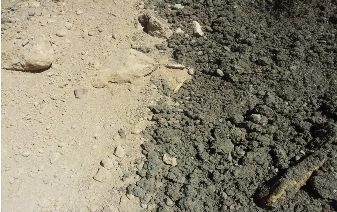
Εικόνα 6. Αριστερά παρθένο χώμα , δεξιά χώμα με ιλύ ύστερα από 3 φορές επαναχρησιμοποίηση και άρα τελική περιεκτικότητα ιλύος της τάξεως του 12%
