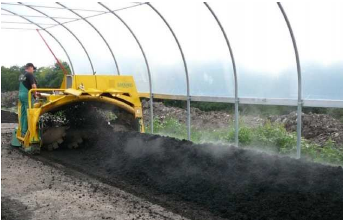
Εικόνα 5. Βιολογική ξήρανση εντός θερμοκηπίου με αυτοκινούμενο αναστροφέα
