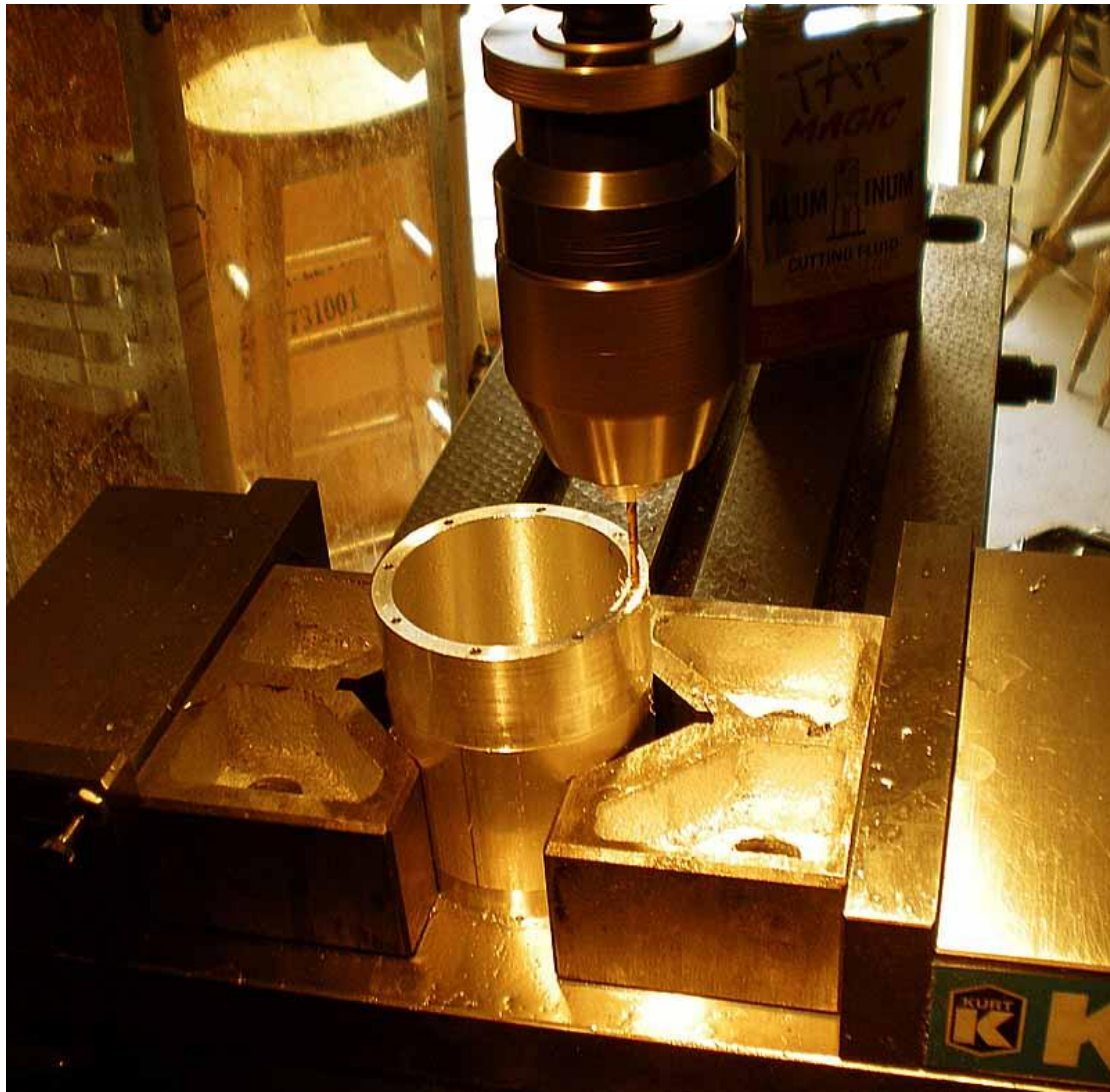
Εικόνα 4.11: Χρησιμοποίηση καβαλέτων V για υποστήριξη κυλινδρικού τεμαχίου
