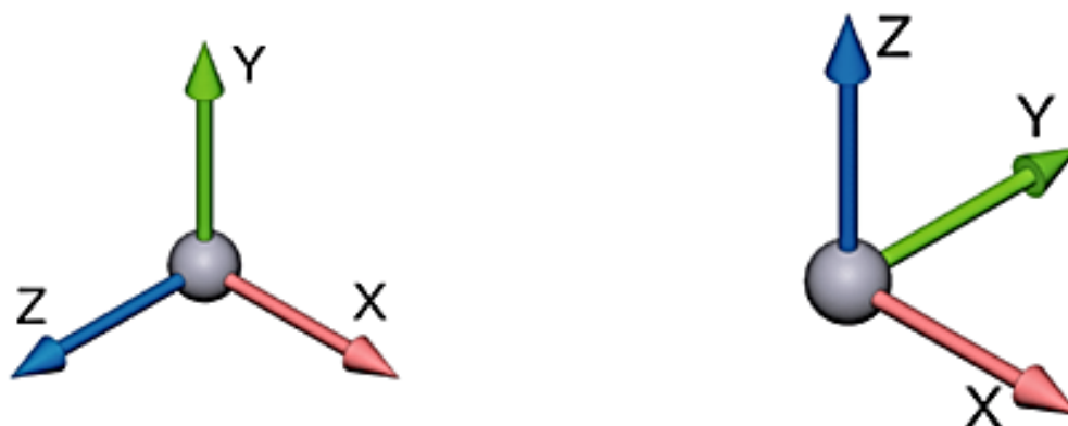
Εικόνα 5.2: Το σύστημα συντεταγμένων στο Solidworks (αριστερά) και το σύστημα συντεταγμένων στο SolidCam (δεξιά)
