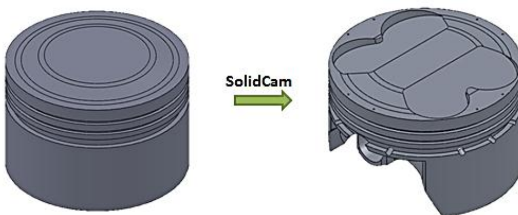
Εικόνα 5.1: Το τεμάχιο στην αρχική και την τελική μορφή του
