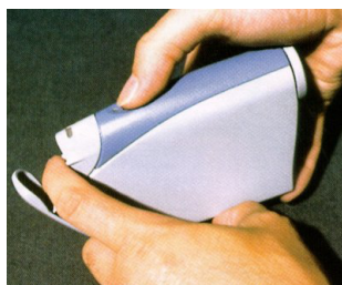
Σχήμα 3.3: Εναλλακτικός τρόπος λήψης αίματος για μέτρηση της γλυκόζης με χρήση laser
