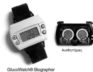
Σχήμα 3.7: Αισθητήρας Αντίστροφου Ιονισμού (Cygnus GlucoWatch)
