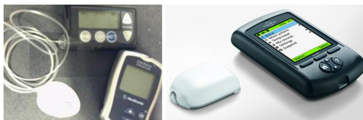
Σχήμα 3.15: Αντλία με σετ έγχυσης (αριστερά) και αντλία τύπου patch (δεξιά) [24]
