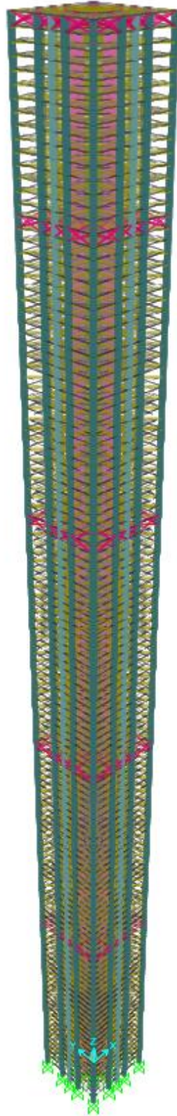
Εικόνα 4.10 : Το τετράγωνο μοντέλο-Υπερπλάισιο στο SAP2000
