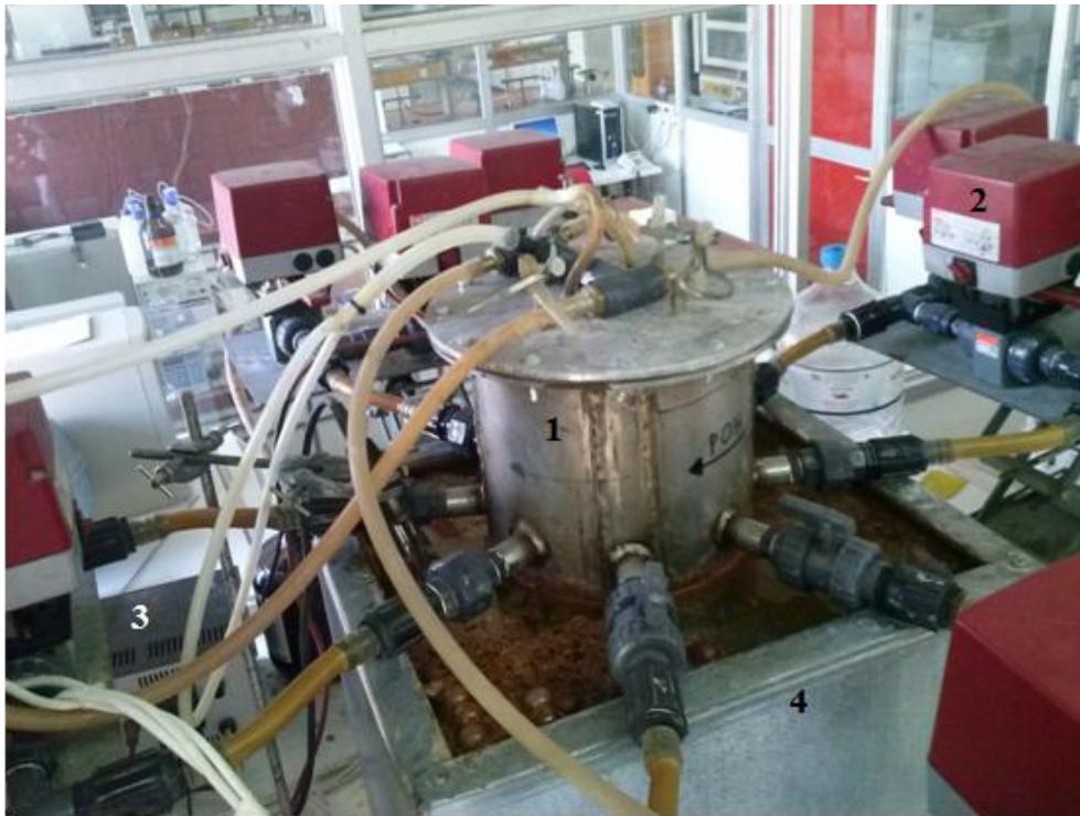
Εικόνα 14: Πειραματική διάταξη του αντιδραστήρα PABR (1). Στην άνωθι εικόνα διακρίνονται οι ηλεκτρονικές βάνες (2) και η συνδεσμολογία τους, ο θερμοστάτης (3) και το υδατόλουτρο (4) που περιβάλλει τον αντιδραστήρα
