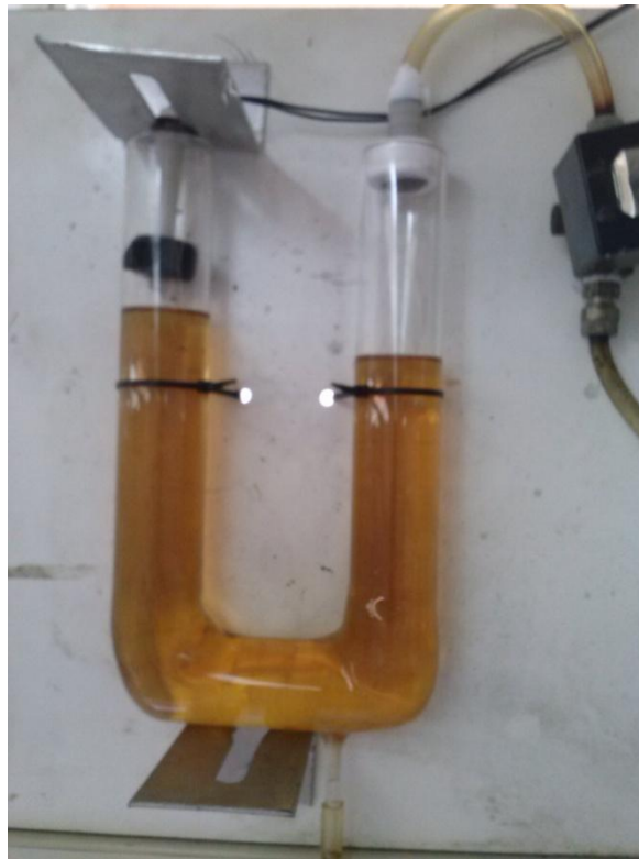
Εικόνα 12: Διάταξη της συσκευής εκτόπισης, όπου διακρίνεται ο σωλήνας τύπου U και ο πλωτήρας
